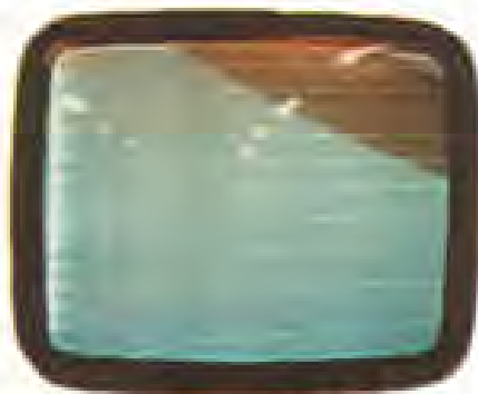
شکل ۱-۳۲- تصویر به صورت خطوط مورب
