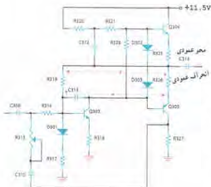
شکل ۲-۵۷- تقویت کننده عمودی
