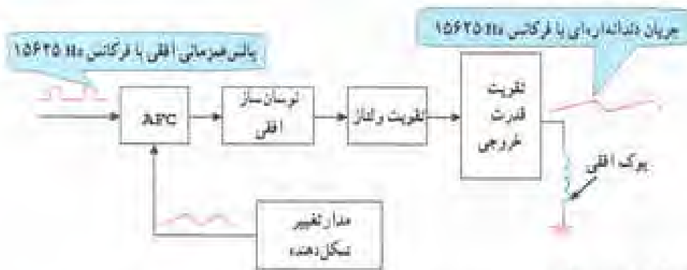
شکل ۳-۳۰ اعمال جریان دندان‌اره‌ای با فرکانس ۱۵۶۲۵ Hz به یوک افقی
