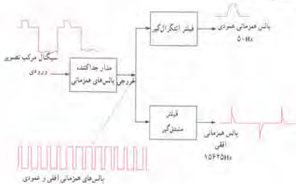
شکل ۱-۳- ورودی و خروجی طبقه همزمانی
