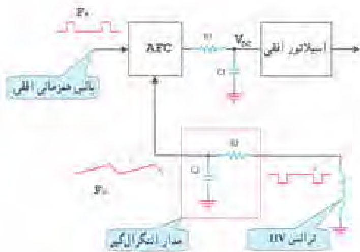
شکل ۳-۴- بلوک دیاگرام مدار AFC
