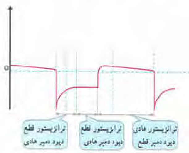
شکل ۳-۲۲- نمایش سیگنال‌های ولتاژ و جریان خروجی افقی
