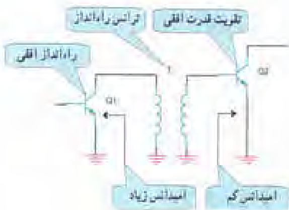
شکل ۳-۵۶- ارتباط ترانس راه انداز افقی با طبقه راه انداز افقی و تقویت کننده قدرت خروجی
