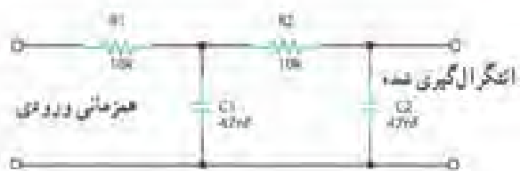
شکل ۱-۲۴ مدار انتگرال گیر دوپل
