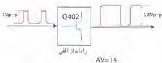
شکل ۳-۶۱ معاینه بهره ولتاژ Q_{401}
