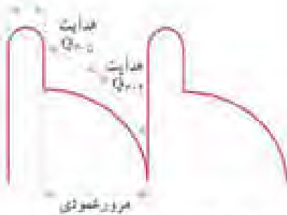
شکل ۲-۶۵- لحظه هدایت ترانزیستورهای خروجی عمودی
