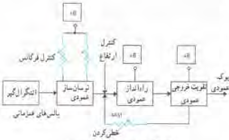
شکل ۴-۵۲- بلوک‌دیگرام طبقه عمودی
