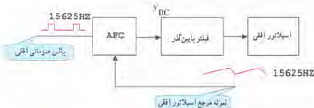
شکل ۳-۳- سیگنال های ورودی و خروجی مدار AFC
