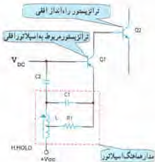
شکل ۳-۵۴- نمونه مدار اسیلاتور افقی
