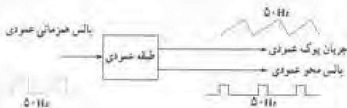
شکل ۲-۲- سیگنال‌های ورودی و خروجی طبقه عمودی
