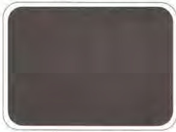
شکل ۴-۶-۲- تلویزیون بدون صوت و رستر
