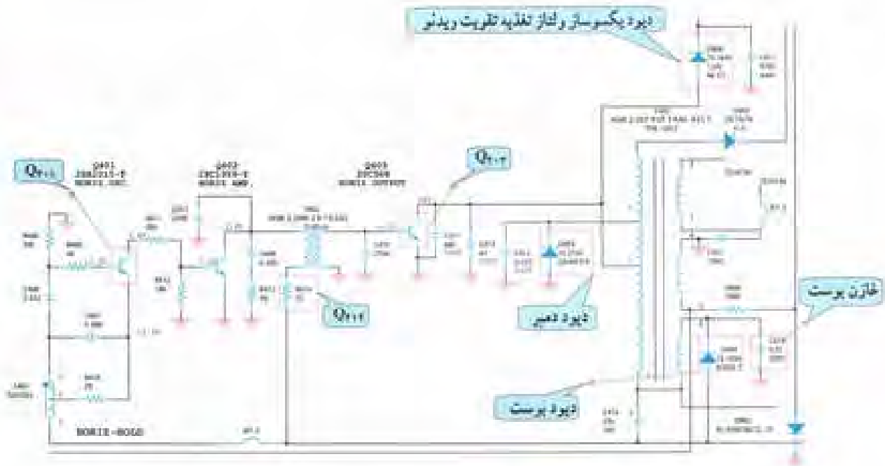
شکل ۳-۹۱- قطعات معیوب در حالت نبود تور صفحه
