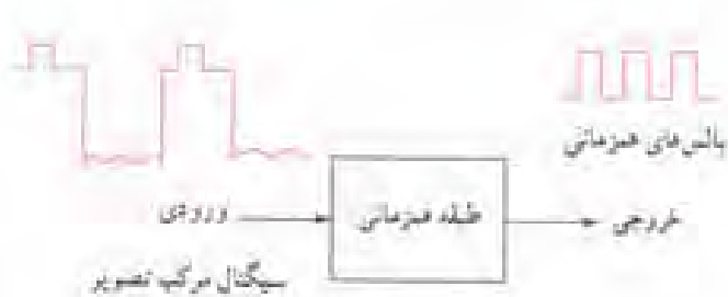
شکل ۱-۴- خروجی همزمانی مستقل از سیگنال تصویر
