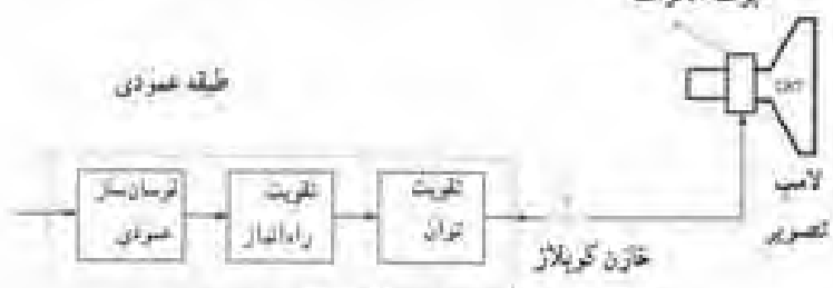
شکل ۲-۱۷- ارتباط طبقه عمودی با لامپ تصویر
