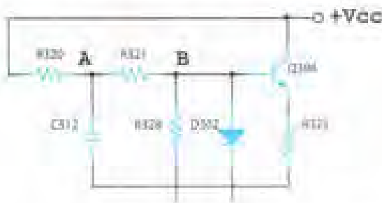
شکل ۶۲-۲ مدار بوت استراب در تقسیم ولتاژ بیس
