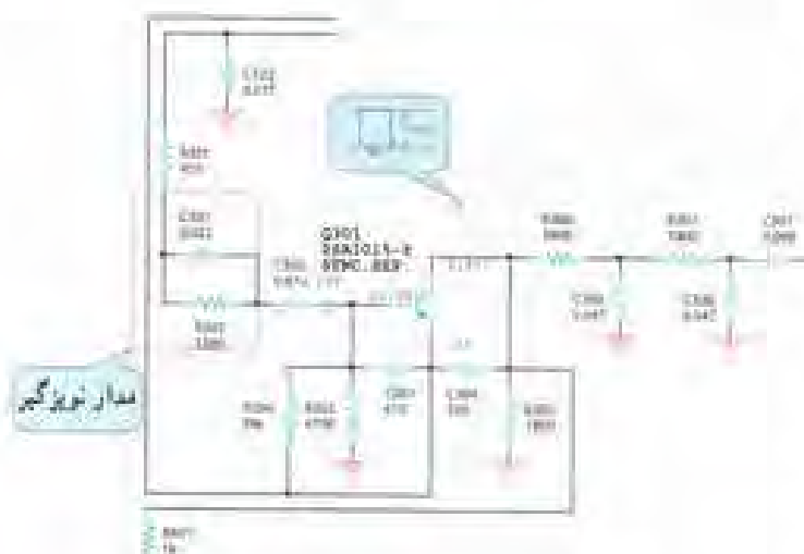
شکل ۲۸-۱ مدار تویزگیر در تلویزیون پلاس
