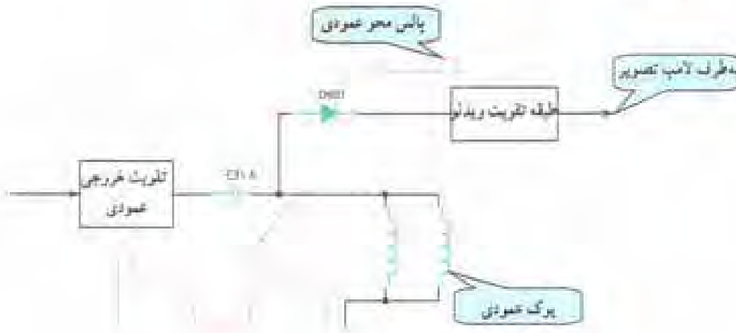
شکل ۲۷-۲- سیگنال‌های خروجی طبقه عمودی
