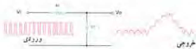
شکل ۱۷-۱ سیگنال شیب‌دار خروجی مدار اشکال‌گیر
