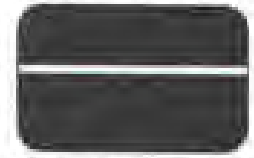
شکل ۲-۱۸- عیب مربوط به از کار افتادن طبقه نوسان ساز عمودی
