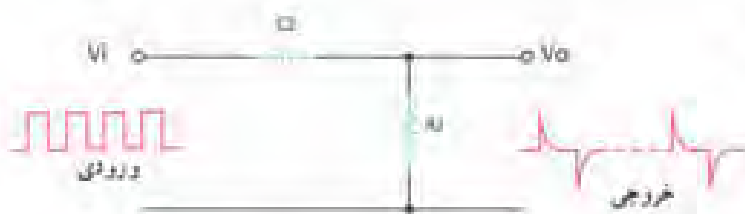
شکل ۱-۱۸- پالس سوزنی شکل در خروجی مدار مشتق‌گیر
