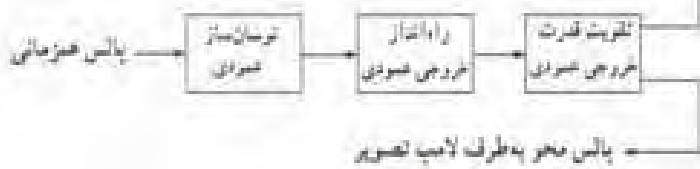
شکل ۲-۴۱- بلوک دیاگرام طبقه عمودی
