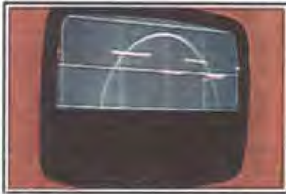
شکل ۲-۹۷- سیاه شدن تصویر از پایین صفحه
