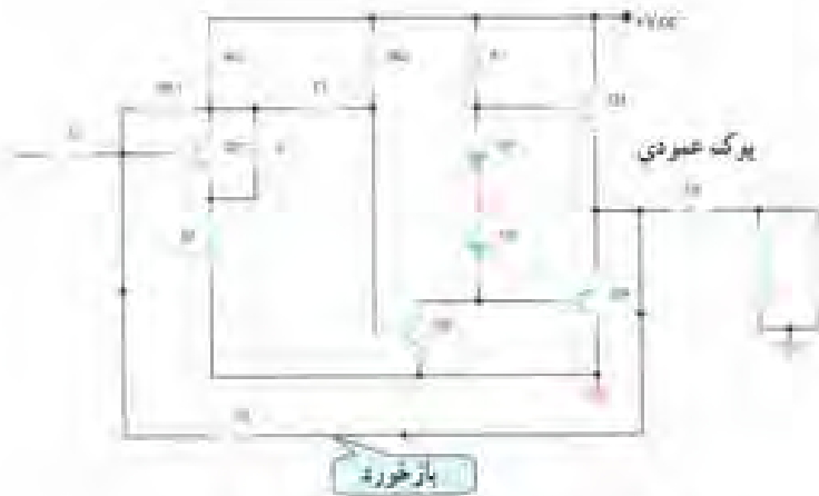
شکل ۲-۲۰- نوسان ساز عمودی و تقویت کننده های آن
