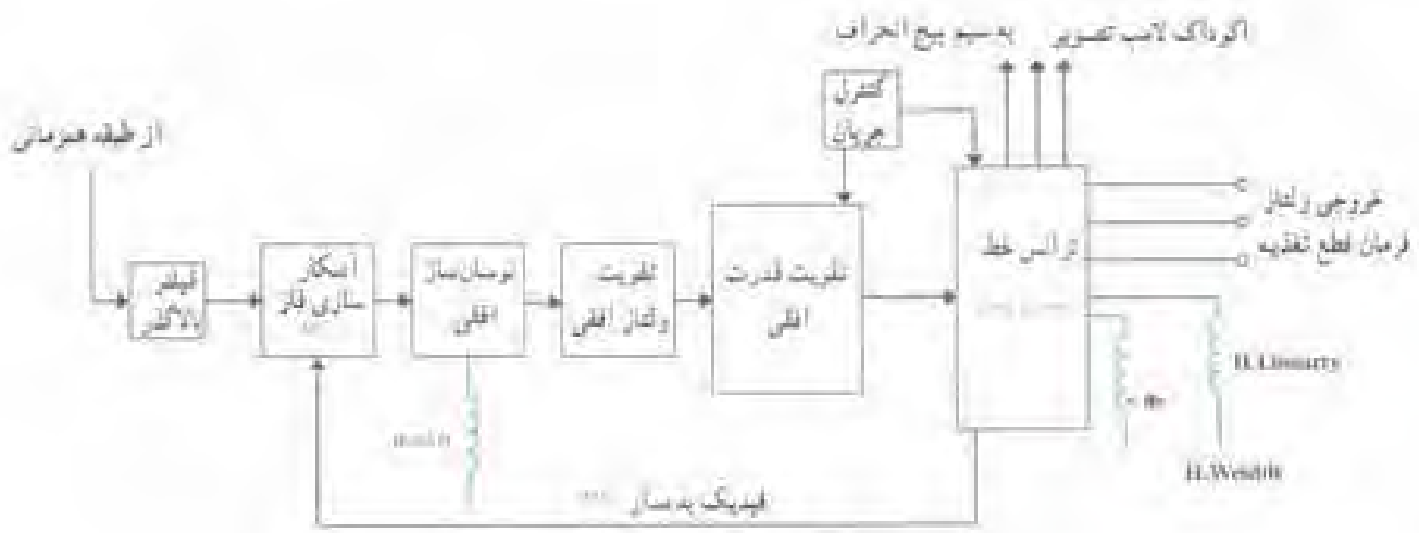
شکل ۶-۲- بلوک دیاگرام طبقه افقی
