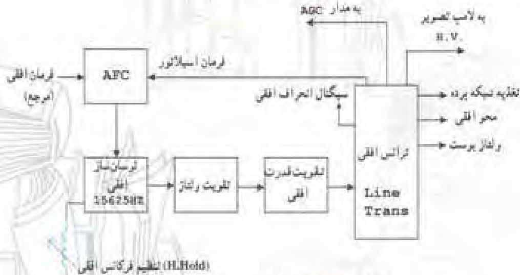
شکل ۳-۱- بلوک دیاگرام سیستم انحراف افقی
