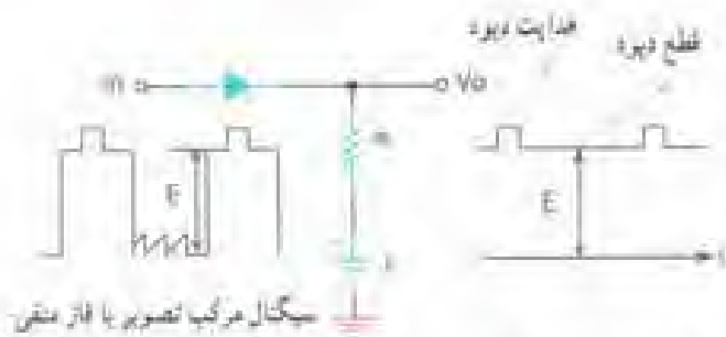
شکل ۱-۵ مدار جداکننده دیودی با ورودی سیگنال مرکب تصویر با فاز منفی
