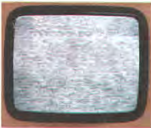
شکل ۲۸-۴ تصویر برفکی بدون صوت
