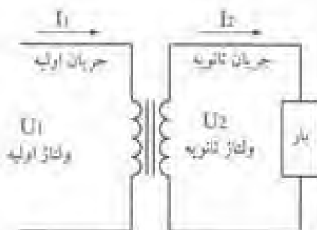
شکل ۱۵-۴- اگر به ثانویه یک ترانسفورماتور یک بار وصل کنیم، جریان اولیه ترانسفورماتور افزایش می‌یابد.
