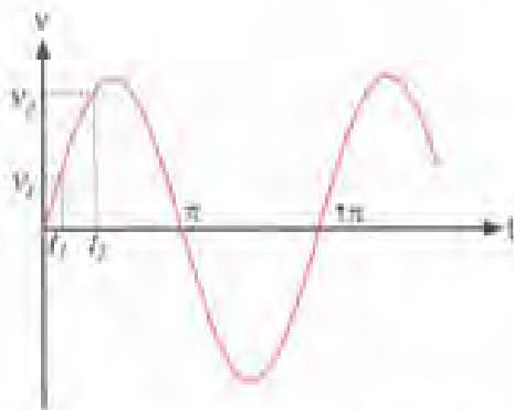
شکل ۱-۲۷- v_1 و v_2 مقادیر لحظه‌ای ولتاژ هستند.
