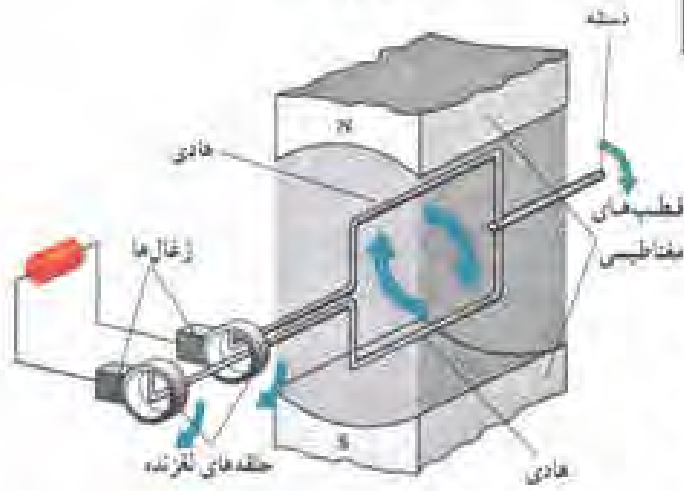
شکل ۱-۲۱- ساختمان یک ژنراتور AC ساده
