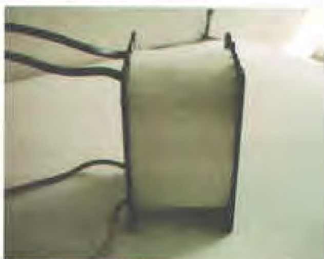
شکل ۴-۵۸: کاغذ برشمان را یک دور کامل روی سیم پیچ ثانویه قرار داده و با چسب آن را محکم کنید.
