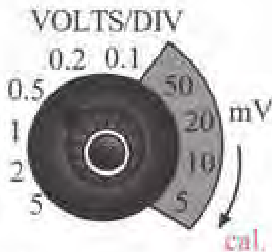
شکل ۱-۵۴- اعدادی که نشانک مقابل آن قرار می‌گیرد میزان انحراف اشعه را در جهت عمودی برای یک خانه مشخص می‌دهد.
