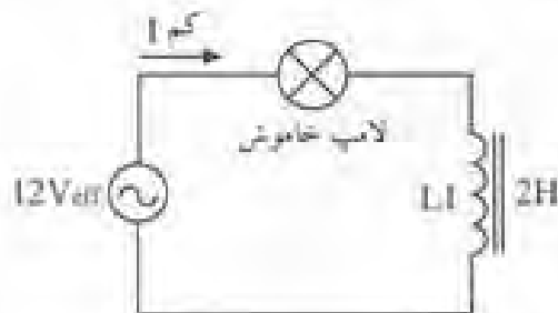
شکل ۲-۳۳ سلف جریان متناوب از خود یک نوع مقاومت خاص نشان می‌دهد. بنابراین در مدار جریان کم می‌شود و لامپ را روشن نمی‌کند.
