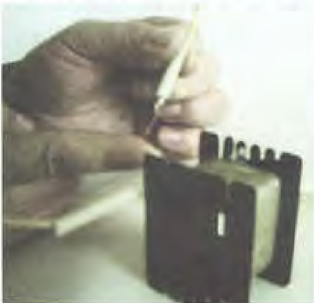
شکل ۲-۴۵- به کمک و ارنیش محل لحیم سیم افشان و لاک‌ی را بیوشانید.
