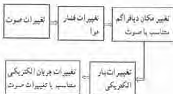
شکل ۲۵-۵۵ ساختمان داخلی میکروفون خازنی
