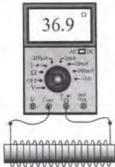
شکل ۲-۳۱ یک سلف علاوه بر اندوکتانس یک مقاومت اهمی نیز دارد. اهم متر فقط مقاومت اهمی سلف را اندازه می‌گیرد.
