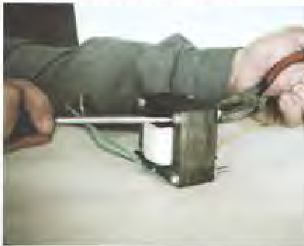
شکل ۴-۶۳ به کمک چهار عدد پیچ و مهره هسته ترانسفورماتور را محکم کنید.
