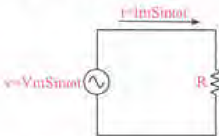
شکل ۲-۳- اگر یک منبع سینوسی به دوسر یک مقاومت اهمی وصل شود در مقاومت جریان سینوسی جاری خواهد شد.
