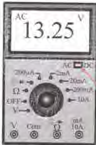
شکل ۱۲- نحوه تنظیم ولت‌متر AC بر روی یک آمومتر
