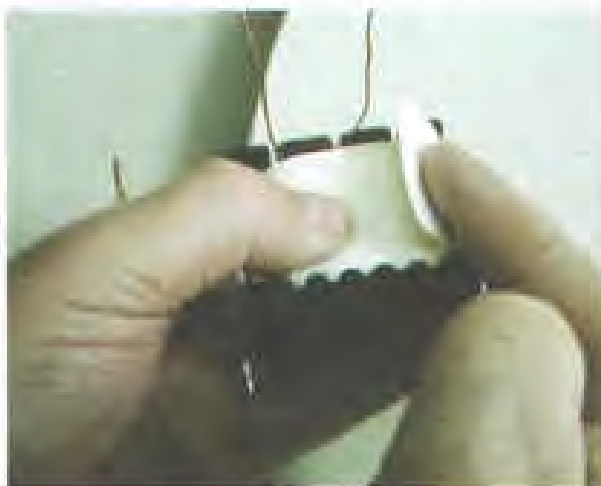
شکل ۴-۵۲ کاغذ برشمان را یک دور کامل روی سیم بیج ناتوبه ببجید و با نوار چسب کاغذ آنرا محکم کنید.
