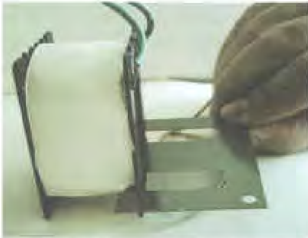
شکل ۴-۵۹- نحوه‌ی قرار دادن اولین ورقه ترانسفورماتور.
