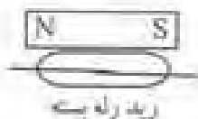
شکل ۱۳ نحوه‌ی باز و بستن یک Reed Relay به کمک یک آهنربای دائم
