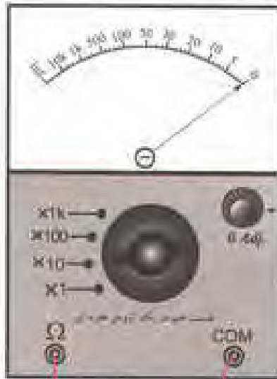
شکل ۵-۱۷- نحوه تنظیم صفر اهم متر
