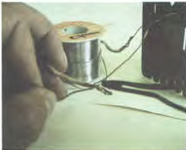
شکل ۲-۴۴- سیم‌های افشان قطع‌اندود شده را به سیم‌های لاک‌ی لحیم کنید.
