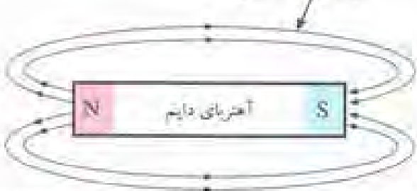
شکل ۱-۵-۳ در اطراف آهنربای دائم، همیشه فوران مغناطیسی (خطوط نیروی مغناطیسی) وجود دارند.
