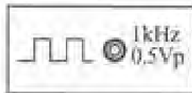
شکل ۴۸- این ترمنال روی اسیلوسکوپ قرار دارد و فرکانس ۱kHz با دامنه ۰/۵ ولت را جهت تنظیم پروب تأمین می‌کند.
