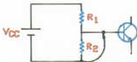
شکل ۴-۲: مدار در حالت اتصال کوتاه R_2
