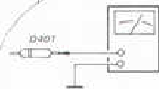
شکل ۱۲.۷: مراحل تنظیم اسپلاتور و کادر آنتن گیرنده چهار موج روی باند MW
