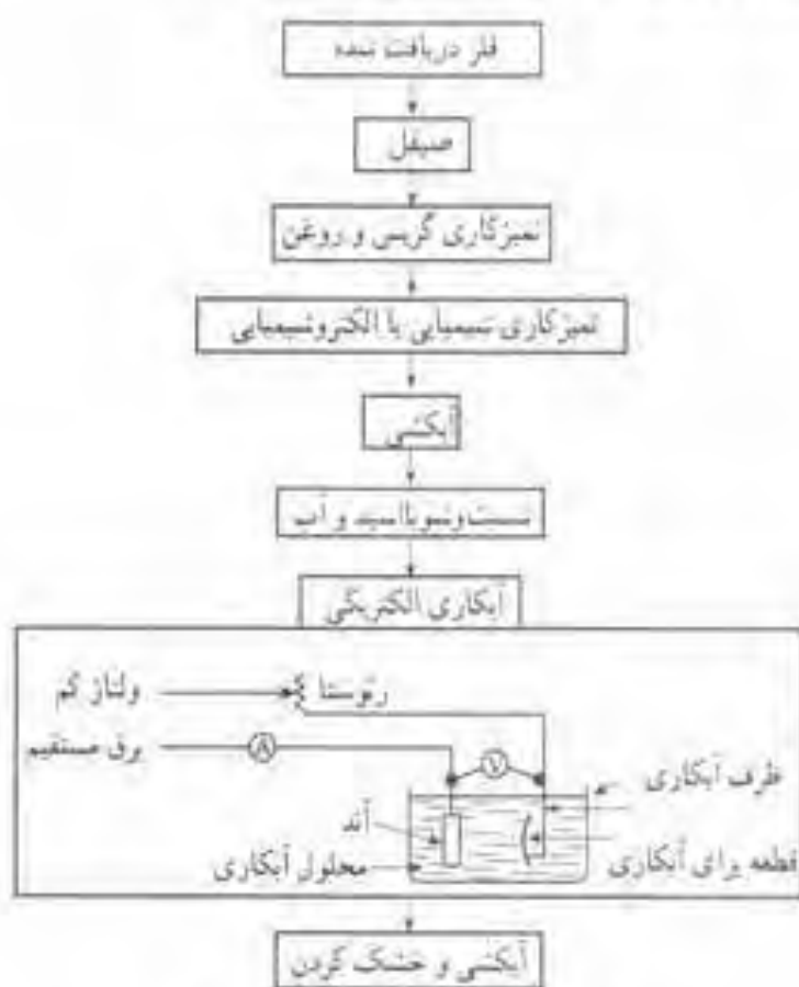
شکل ۶-۳ قسمت های مختلف یک واحد آبکاری
