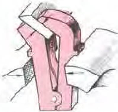
استفاده از گیره کج برای بستن کمره تحت زاویه معین
