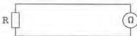
شکل ۵۴-۵- مدار اتصال اهم متر به مقاومت
