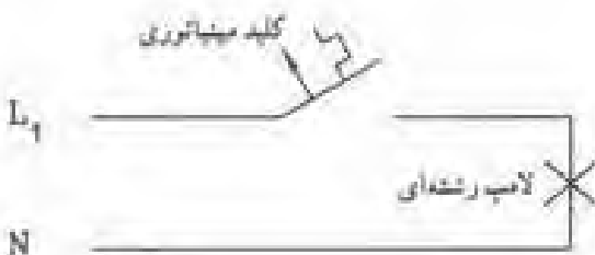
شکل ۱-۱۳- نحوه قرار گرفتن کلید مینیاتوری در مدار
