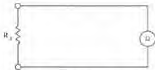
شکل ۵-۳۱- طرز قرارگیری مقاومت با اهم‌تر
