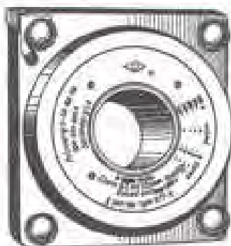
شکل ۵-۲۹ ب - ترانسفورماتور جریان با هسته مغناطیسی دایره‌ای شکل و سیم پیچی‌های اولیه و ثانویه
