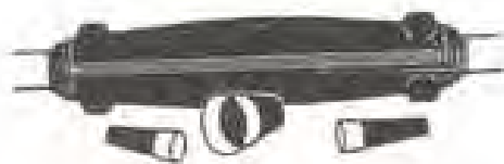
شکل ۲۵-۶- پس از سخت شدن رزین قیف‌ها بریده شوند.
