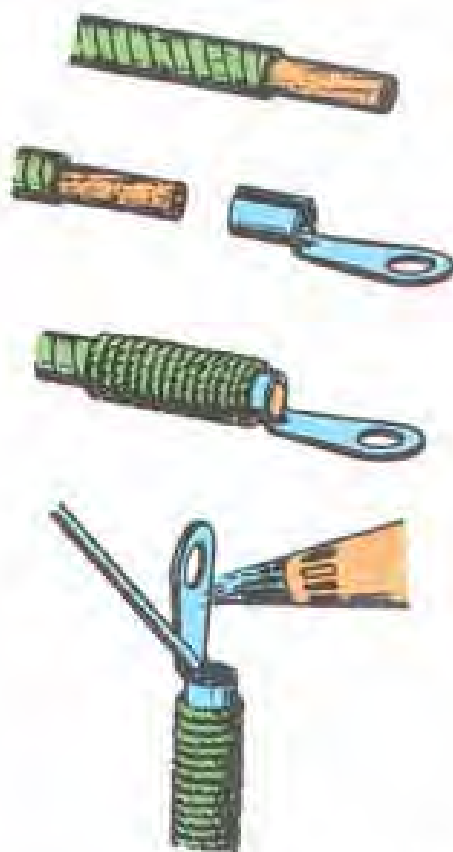
شکل ۲۸-۵- مراحل لحیم کاری کابل نسو
