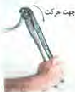
شکل ۹-۴ - طریقه‌ی باز و بسته کردن لوله به وسیله‌ی آچار لوله گیر
