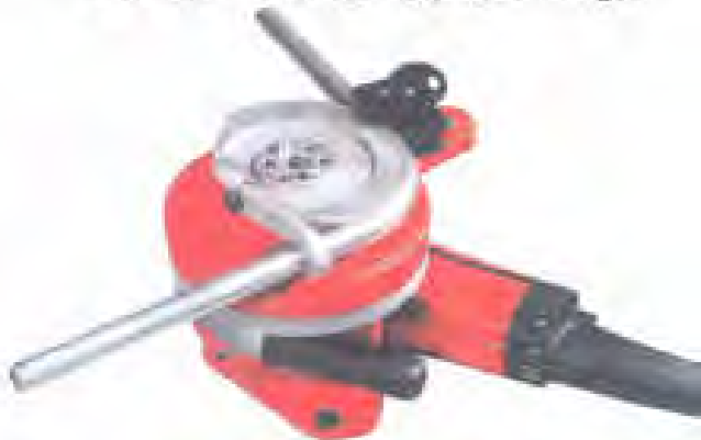
شکل ۴-۶- لوله خم کن دستی با دو نمونه تابلون مربوطه
