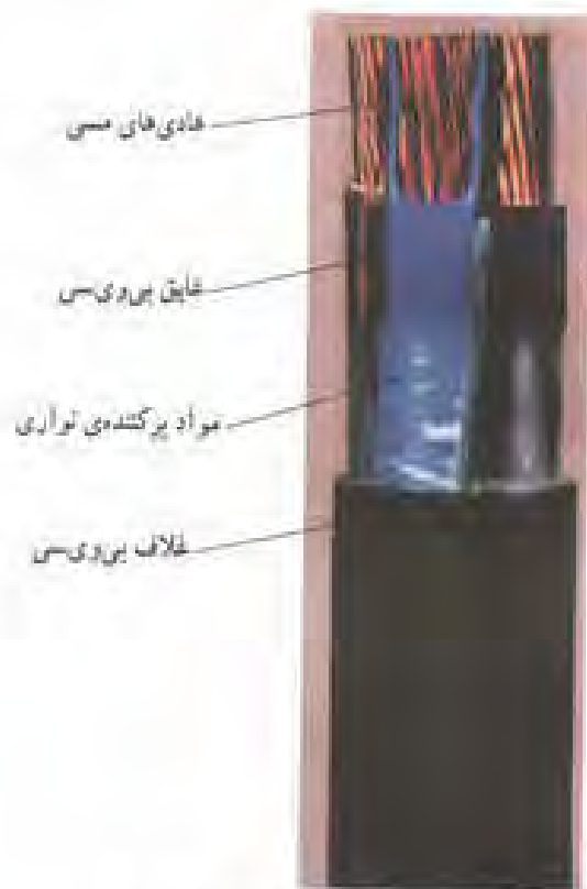
شکل ۵-۶ - کابل با غلاف PVC
