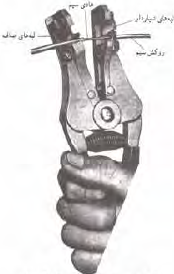
شکل ۱-۹ - سیم لخت‌کن خودکار در حال روکش‌برداری
