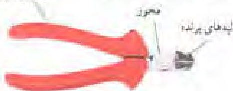
ب - سیم‌چین فشار قوی با دسته‌ی عایق
