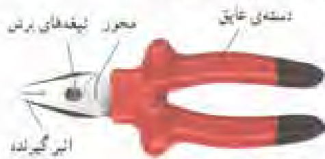
ب - انبردست فشار قوی با دسته‌ی عایق
