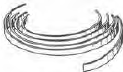
شکل ۳-۵- تسمه‌های مخصوص بست
