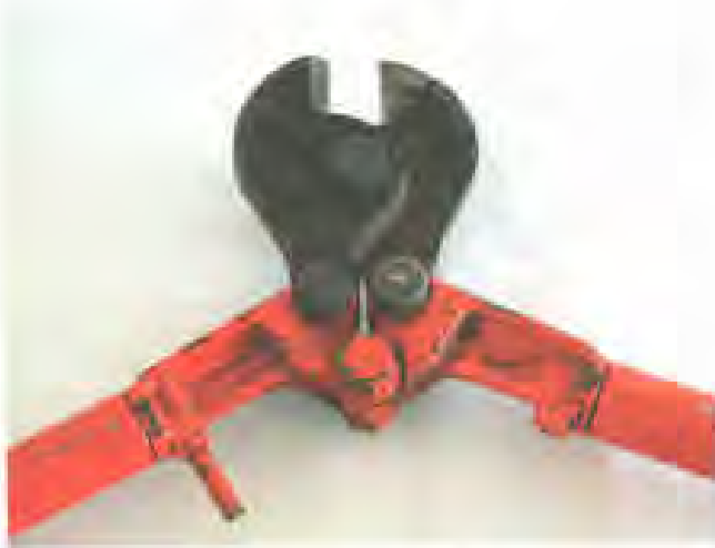
شکل ۵-۷۳- قیچی کابل بری
