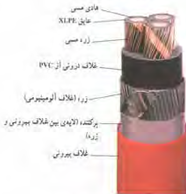
شکل ۵-۷ - کابل با غلاف آلومینیومی
