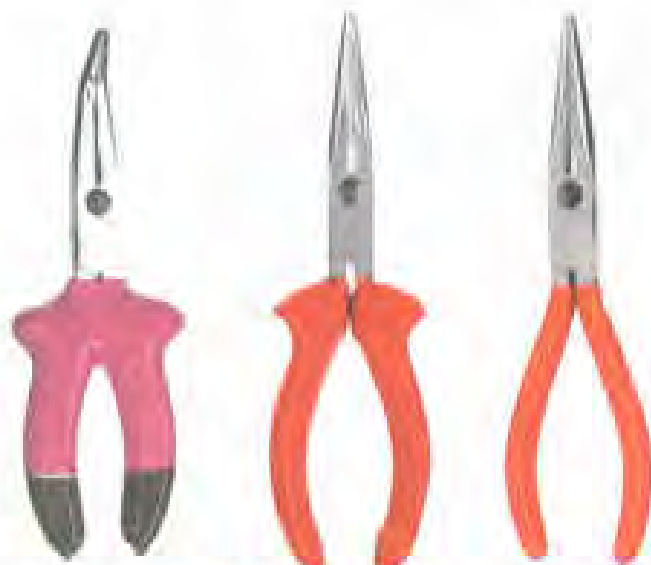
الف - دم باریک دسته عایق ب - دم باریک دسته عایق ج - دم باریک دسته عایق عایق معمولی توک گرد فشار قوی با نوک بلند فشار قوی با توک کج ۲۵
