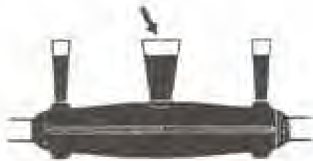
شکل ۲۲-۶- ماده‌ی رزین تا \frac{1}{4} ارتفاع قیف ریخته می‌شود.
