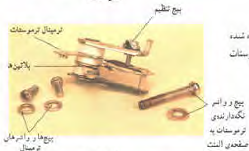
شکل ۳-۴۲ بیج نگه‌دارنده‌ی ترموستات به صفحه‌ی المنت
