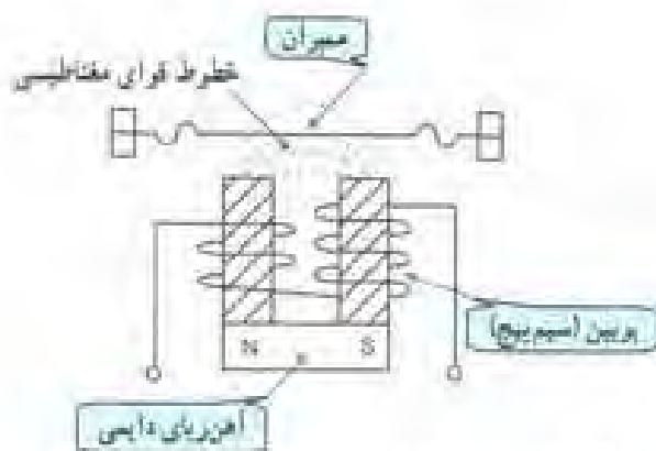
شکل ۱-۱۲۰- ساختمان داخلی میکروفون الکترومغناطیسی
