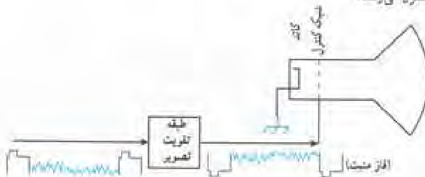
شکل ۱۴-۱ اتصال سیگنال مرکب تصویر با فاز مثبت به شبکه کنترل
