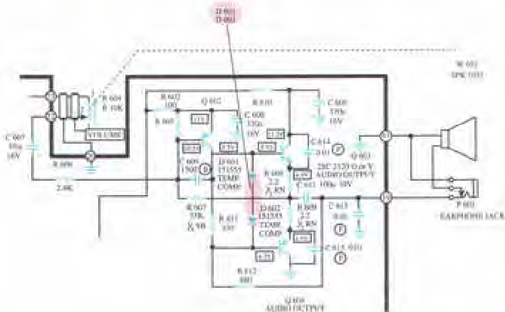
شکل ۲-۳۵- سرچشمیت D_{101} و D_{102} روی نقشه
