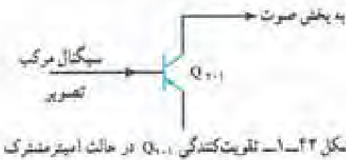
شکل ۱-۲۱- مدار اولین طبقه تقویت کننده تصویر
