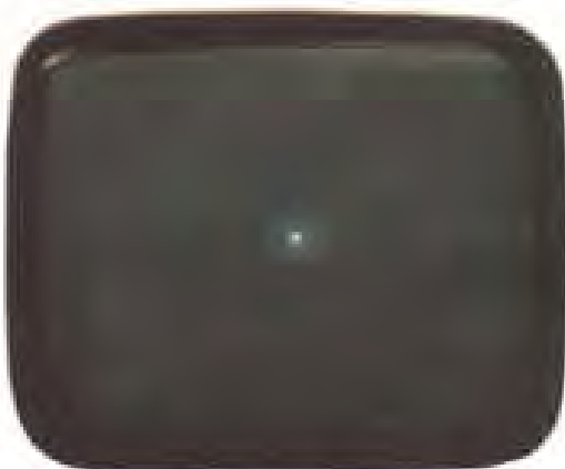
شکل ۱۲۰-۱ نمایش نقطه سوز شدن لامپ تصویر
