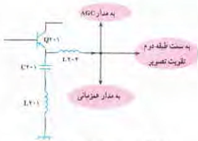
شکل ۱-۴۵ وجود سه اتصالی در امپتر Q_{201}
