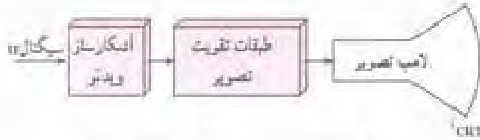
شکل ۱-۱- ورودی و خروجی طبقه تقویت تصویر.
