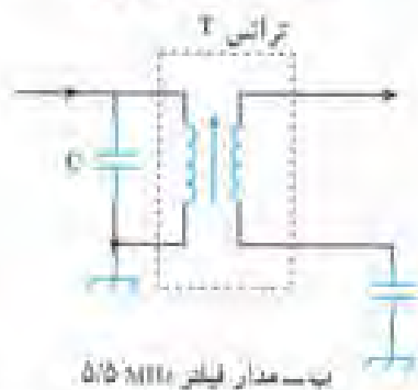
شکل ۱۶-۱-۲ مدار یک نمونه فیلتر جداساز صوت از تصویر و شکل ظاهری آن
