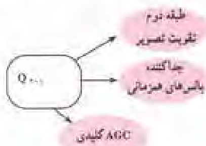
شکل ۱-۲۴- انتساب های خروجی امپتر تقویت کننده ویدئوی اول
