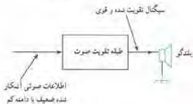
شکل ۲-۱۷ طبقه تقویت‌کننده صوت
