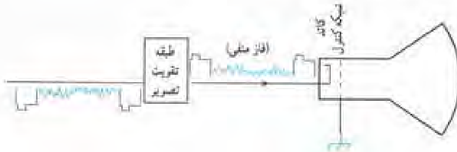
شکل ۱۳-۱ اتصال سیگنال مرکب تصویر با فاز منفی به کاند لایمپ تصویر
