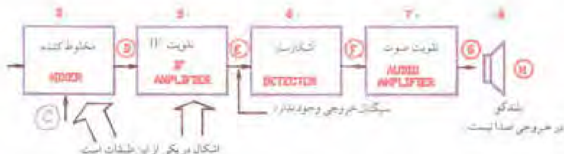
شکل ۱۱-۴- اشکال در سمت چپ بلوک شماره ۵ است
