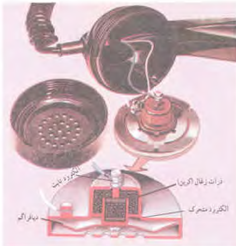
ب - برش میکروفون زغالی شکل ۷-۲ - ساختمان میکروفون زغالی
