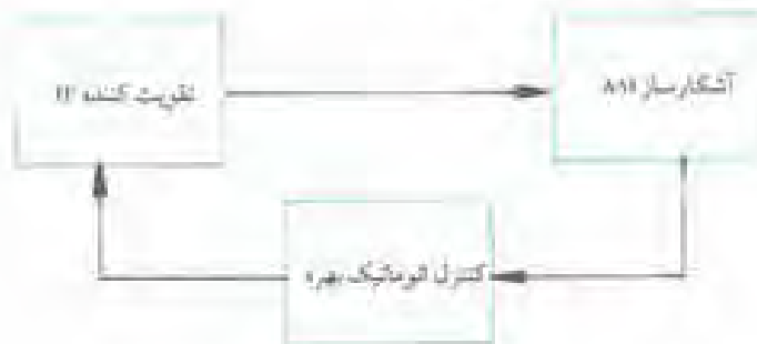
شکل ۸-۶- بلوک دیاگرام مدار AGC
