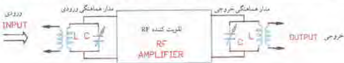
شکل ۴-۱ یک تقویت کننده رادیویی با مدار هماهنگی ورودی و خروجی
