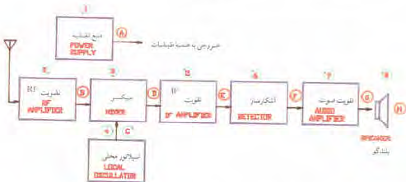
شکل ۱۱-۱ - بلوک دیگرام گیرنده سوبرهترودین
