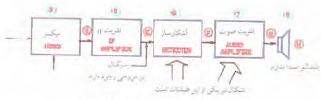
شکل ۱۱-۹: اشکال در سمت راست بلوک شماره ۵ است.
