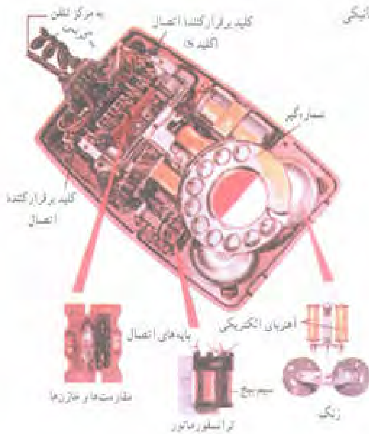
شکل ۲-۳۰ نمای داخلی تلفن رومیزی الکترومکانیکی و تعدادی از قطعات آن
