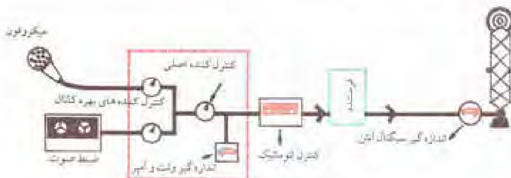
شکل ۶-۳- بلوک دیاگرام کلی فرستنده
