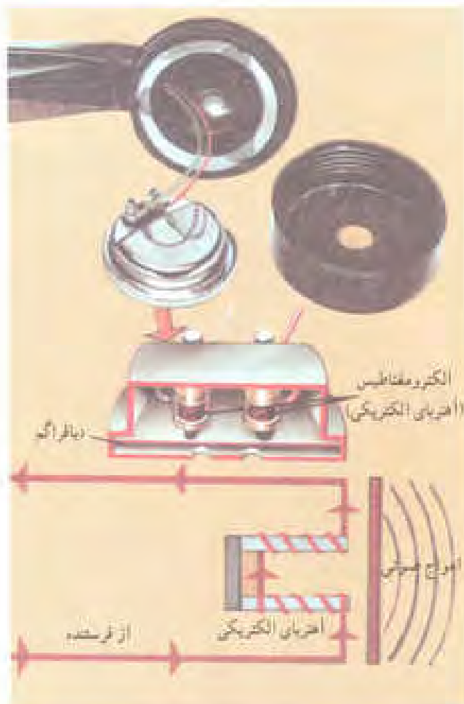
شکل ۲-۱۳ گونسی الکترومغناطیسی واقعی و اتصال آن به مدار
