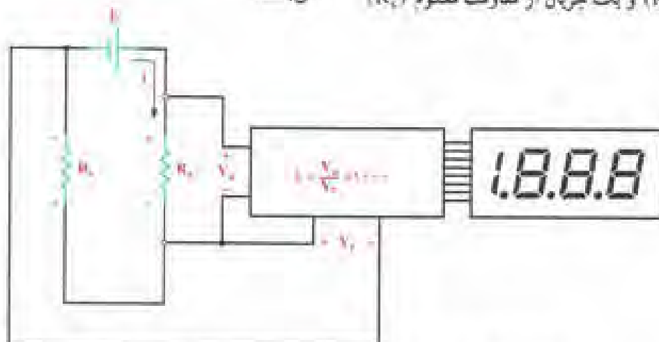
شکل ۱۳-۵ نحوه‌ی اندازه‌گیری مقاومت اهمی به کمک ولت‌متر دیجیتالی
