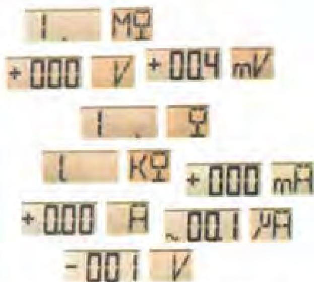
الف- نشان‌دهنده‌های LCD برای نمایش مقادیر واحدها، قطب و نوع اندازه‌گیری و نقاط شناور
