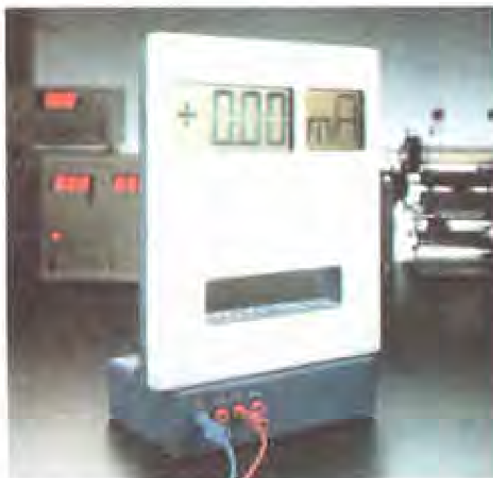
ب- یک آمومتر دیجیتالی هنگام اندازه‌گیری جریان
