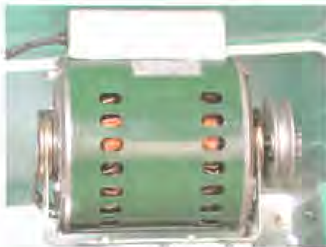
شکل ۱-۲۸- موتور تک‌فاز با راه‌انداز خازنی
