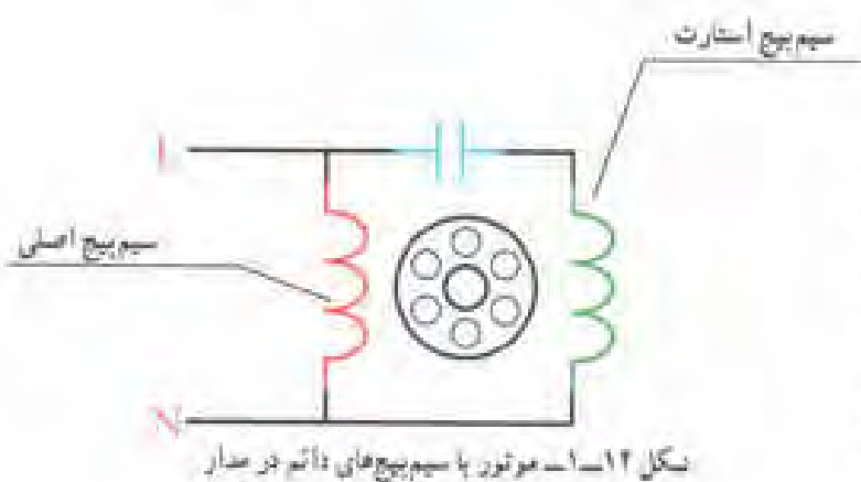
شکل ۱۳-۱- موتور با سیم‌پیچی طرح دو فاز
