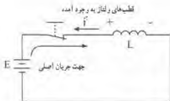
شکل ۲-۷۵- طبق قانون لنز، i مخالف جهت جریان اصلی است که ولتاژ دو سر سلف را به وجود آورده است.
