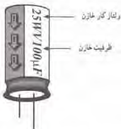
شکل ۴-۱۶- بر روی خازن‌های ساخته شده، ولتاژ کار و ظرفیت خازن را می‌نویسند.
