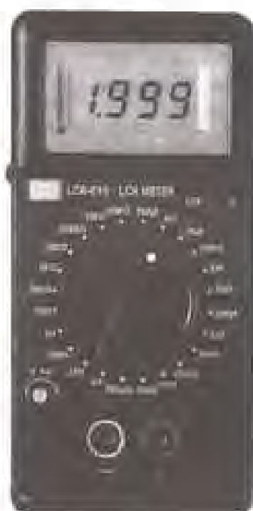
شکل ۴-۱۷- یک نمونه دستگاه LCR متر که برای اندازه‌گیری ظرفیت خازن، مقاومت اهمی و ضریب خود القایی سلفه به کار می‌رود.
