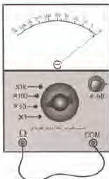
شکل ۴-۱۷ نحوه تنظیم صفر اهم‌متر عقربه‌ای
