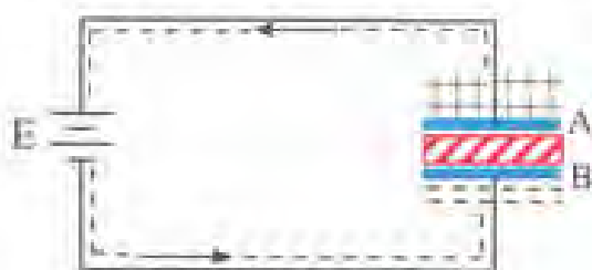
شکل ۲-۲۵ - خازن در حالت شارژ شدن
