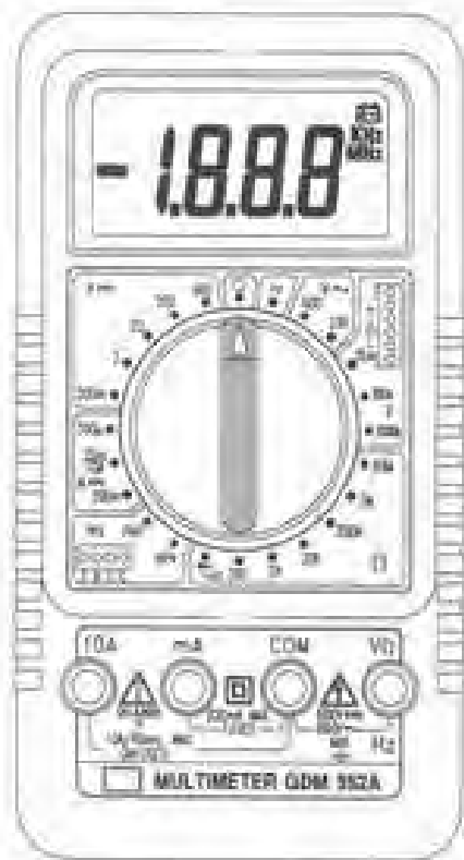
شکل ۲-۱۹- یک نمونه آرومتر دیجیتالی که قادر است ظرفیت خازن را اندازه بگیرد.
