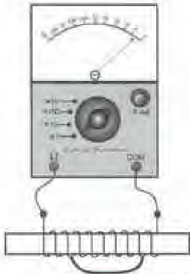
شکل ۸۷-۲- اگر در سلف اتصال کوتاهی رخ داده باشد مقاومت اهمی سلف بسیار کم خواهد شد.
