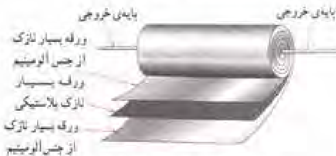
ب - ساختمان داخلی خازن فیلم پلاستیک
