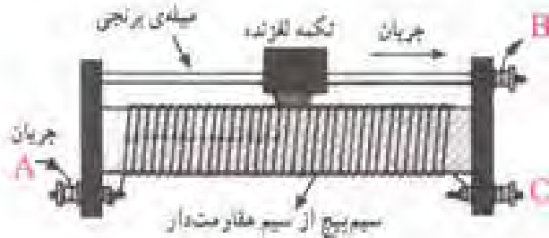
شکل ۱-۱۱۶- با تغییر نکته لغزنده روی سیمه برنجی مقاومت اهمی بین A و B تغییر می‌کند.
