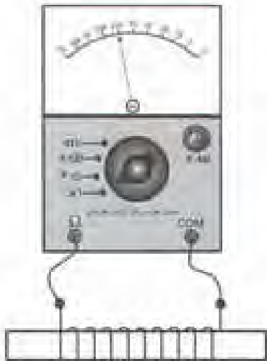
شکل ۸۶-۲- اگر مقاومت اهمی سلف، تغییر نکرده باشد سلف سالم است.
