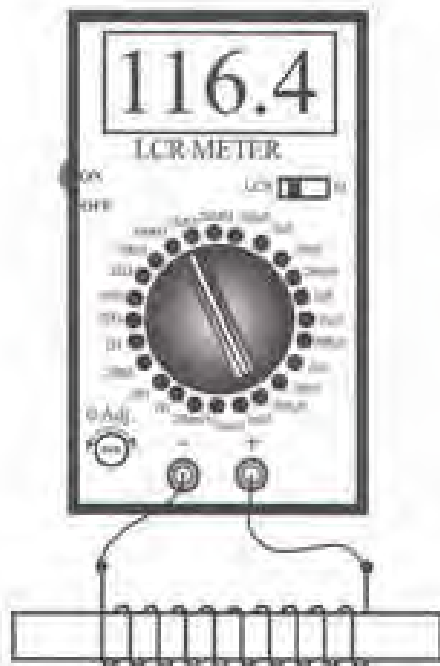
شکل ۶۹-۲ نحوه اندازه‌گیری ضریب خودالقایی یک سلف توسط دستگاه LCR متر
