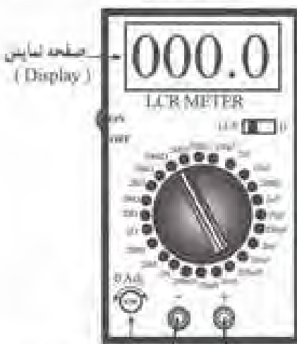
شکل ۶۹-۲ نحوه اندازه‌گیری ضریب خودالقایی یک سلف توسط دستگاه LCR متر
