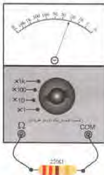
شکل ۸۳- نحوه اندازه گیری مقاومت اهمی با اهم متر
