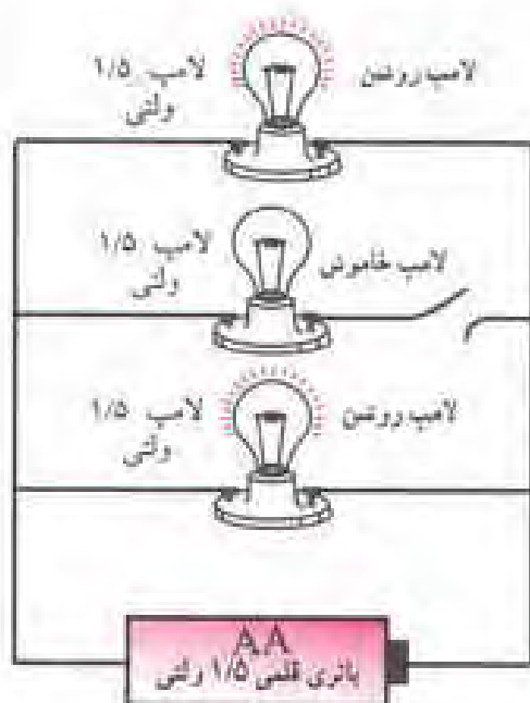
شکل ۱-۴۰- در مدار موازی، اگر یکی از مصرف‌کننده‌ها قطع شود، تأثیری روی بقیه مصرف‌کننده‌ها نمی‌گذارد.
