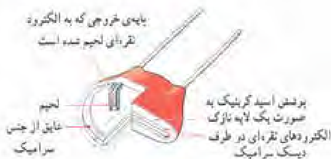
ب - ساختمان داخلی خازن سرامیکی
