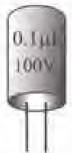
شکل ۲-۱۴- بر روی خازن ها ظرفیت و ولتاژ مجاز کار آن را می نویسند.
