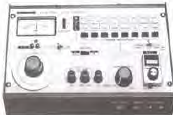
شکل ۴-۱۸- یک نمونه دستگاه LCR متر که با آن می‌توان ظرفیت خازن را اندازه گرفت.
