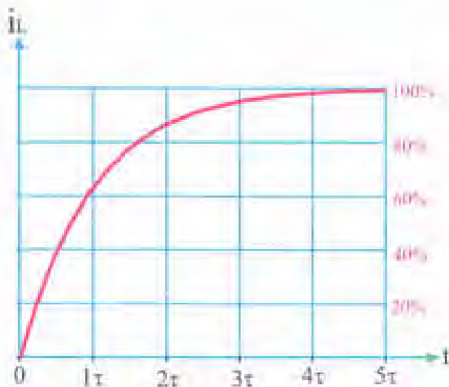
شکل ۲-۷۷- نحوه افزایش جریان در یک سلف
