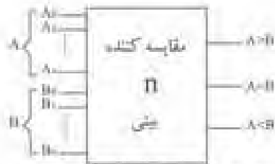
شکل ۷-۱۸ بلوک دیاگرام یک مقایسه‌کننده \Pi بیتی
