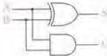
شکل ۷-۸۳ - مدار منطقی جمع کننده ناقص
