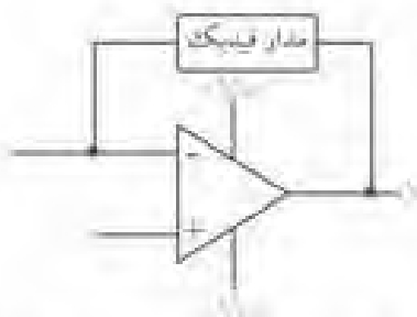
شکل ۱۴-۶ اگر بخواهیم از تقویت کننده عملیاتی به عنوان تقویت سیگنال استفاده کنیم، باید در آن فیدبک منفی به کار ببریم.
