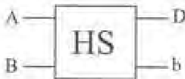
شکل ۷-۹۱ بلوک دیاگرام یک جمع کننده ناقص
