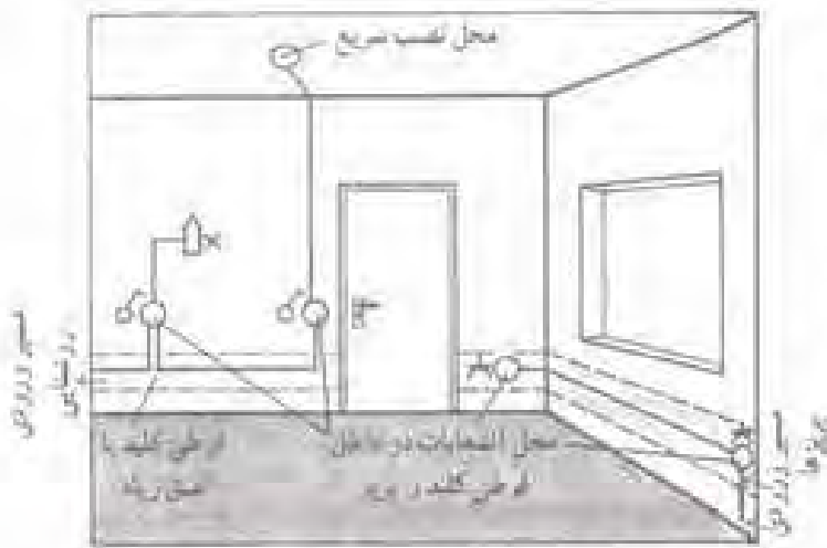
شکل ۳-۶-۲- سیم‌کشی توکار با استفاده از قوطی کلید و پریز به عنوان قوطی تقسیم
