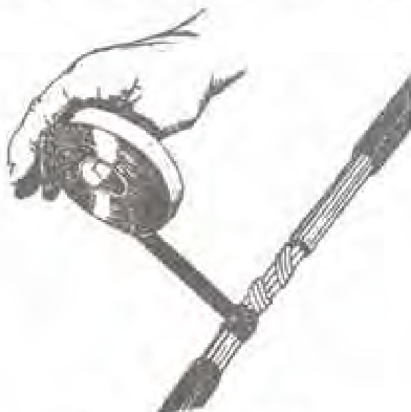
شکل ۴-۷-۱- تواربجی دور اتصالات
