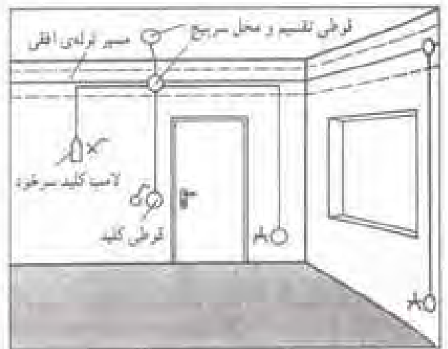
شکل ۳-۶-۱- سیم‌کشی توکار با استفاده از قوطی تقسیم
