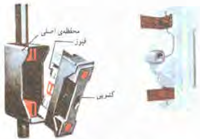
شکل ۲-۷- انواع فیوزهای ساختمان آن‌ها
