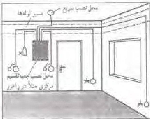
شکل ۳-۶-۳- سیم‌کشی به روش استفاده از جعبه تقسیم مرکزی
