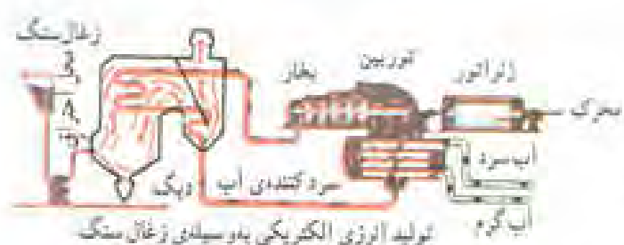
شکل ۱-۲- تولید انرژی الکتریکی به کمک انرژی حرارتی حاصل از احتراق
