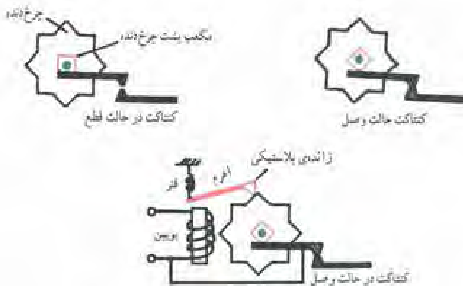
شکل ۵-۲۲ - طریق عمل قطع و وصل کنتاکت‌ها
