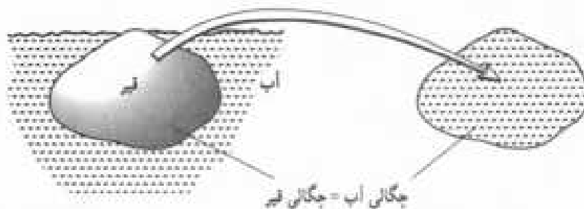
شکل ۲۶-۶ یک جسم وقتی در آب غوطه‌ور می‌شود که نیروی روبه‌بالا با وزن آن برابر باشد.
