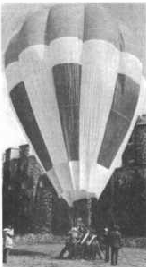
شکل ۶-۲۷ - وزن هوای جابه‌جا شده از وزن بالن و محتویات آن کمتر است.
