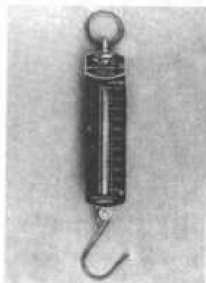
شکل ۱۹-۲ نیروسنج، هر چه نیرو بیش‌تر باشد، فنر نیروسنج بیش‌تر کشیده می‌شود.
