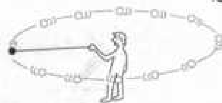
شکل ۳-۵- بزرگی سرعت گلوله ثابت است ولی جهت آن تغییر می‌کند.
