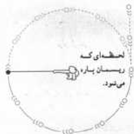
شکل ۳-۶- نیروی لازم برای نگاه داشتن گلوله بر روی دایره به وسیله‌ی ریسمان تأمین می‌شود. پس از پاره شدن ریسمان گلوله بر روی خط راست حرکت می‌کند.
