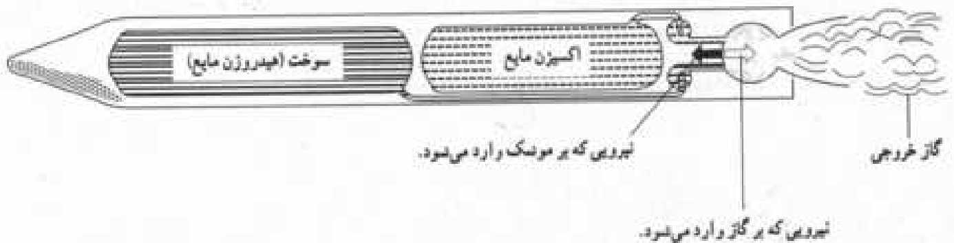
شکل ۳-۲۱- در اثر خروج گاز موشک به جلو رانده می‌شود.
