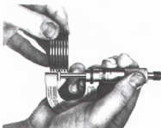
شکل ۲-۲- نحوه در دست گرفتن میکرومتر
