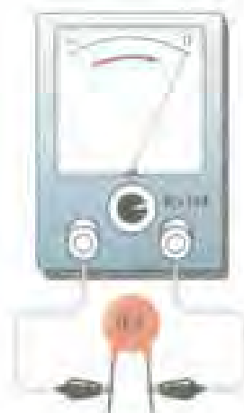
(b) اگر عقربه اهم‌تر روی عدد صفر قرار گرفت نشان می‌دهد خازن اتصال کوتاه است.
