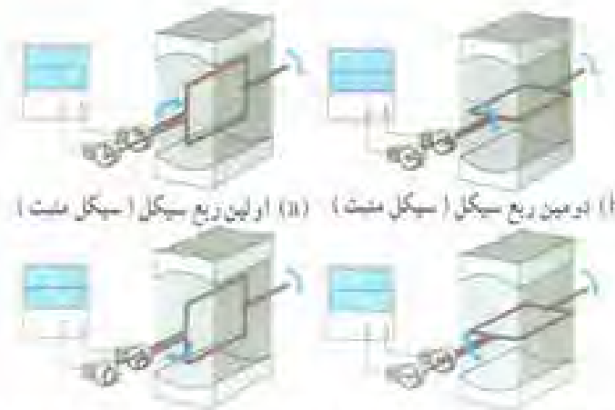
(a) چهارمین ربع سیکل نیم سیکل منفی، (b) اولین ربع سیکل (سیکل مثبت)، (c) سومین ربع سیکل نیم سیکل منفی، (d) دومین ربع سیکل (سیکل مثبت) شکل ۹-۱۶ - وضعیت قرار گرفتن کلاف سیم در زوایای 0^\circ ، 90^\circ ، 180^\circ و 270^\circ درجه
