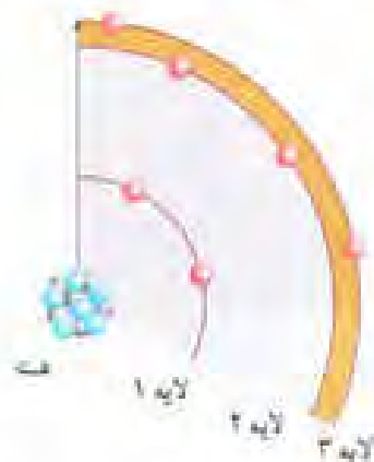
شکل ۱-۷- نحوه قرار گرفتن اتم‌ها روی مدارها و پروتون و نوترون در هسته
