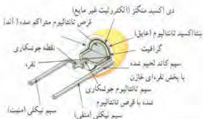
شکل ۸-۳۶ - ساختمان داخلی خازن تانتالیوم
