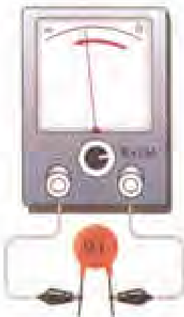
(c) اگر عقربه اهم‌متر در ابتدا روی صفر قرار گرفت و سپس به امنیت بازگشت نشان می‌دهد خازن سالم است.
