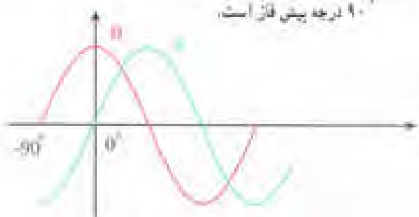
(ii) شکل موج A نسبت به B با اندازه ۹۰ درجه پیش فاز است.
