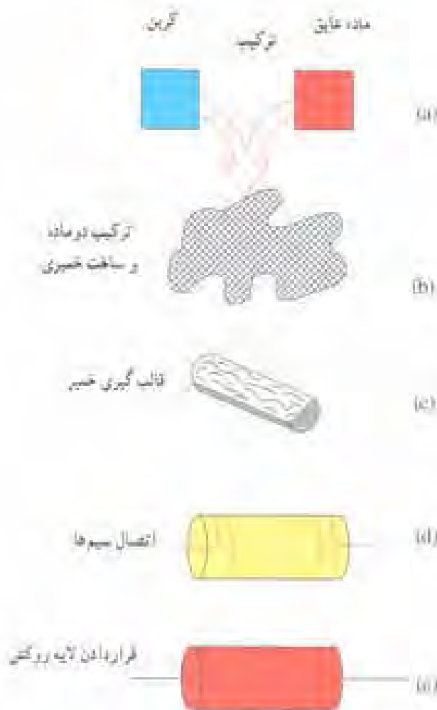
شکل ۳-۲۲ - مراحل ساخت مقاومت توده کربنی
