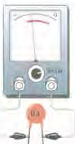
(c) اگر عقربه اهم‌تر در ابتدا روی صفر قرار گرفت و سپس به آهستگی بازگشت نشان می‌دهد خازن سالم است.
