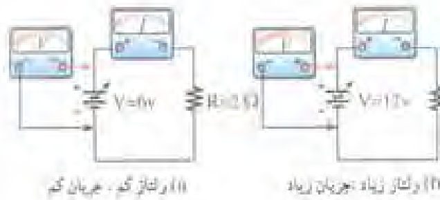
شکل ۴-۱۵- تغییرات ولتاژ و جریان به ازای مقاومت ثابت در یک مدار الکتریکی
