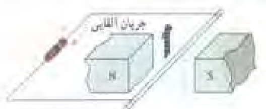
شکل ۹-۱۴ اگر مدار سیم متحرک بسته شود جریان القایی در مدار حضورش کشنده جاری می‌شود.
