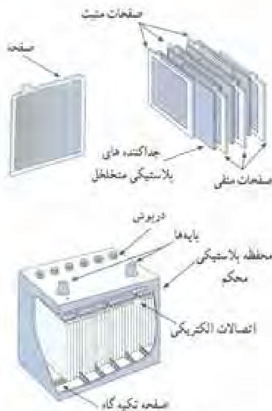
شکل ۵-۱۰۴ ساختمان باتری سرب - اسید
