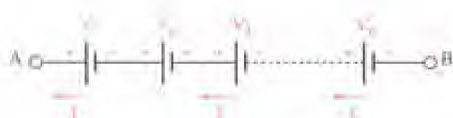
شکل ۵-۱۰۸- جریان عبوری از اتصال سری پیل‌ها
