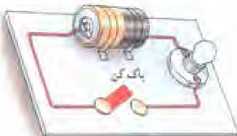
ب) ضریب مقاومت پاگه گن زیاد است در نتیجه با وصل به بیج لامپ روشن نمی شود.
