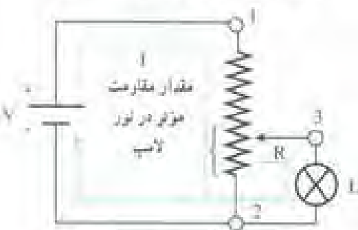
(b) مقاومت پتانسیومتر کم و نور لامپ کم
