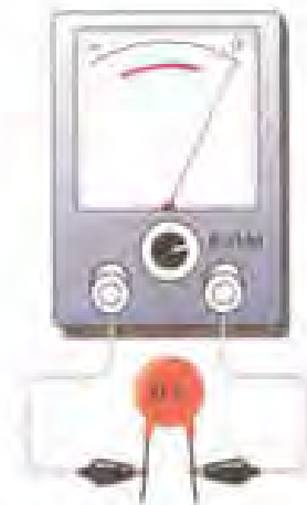
(b) اگر عقربه اهم‌متر روی عدد صفر قرار گرفت نشان می‌دهد خازن اتصال کوتاه است.
