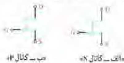
شکل ۷-۳- شمای فنی ترانزیستورهای JFET کانال N و کانال P
