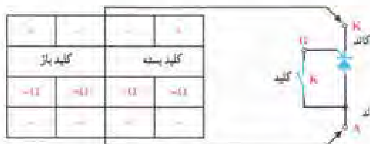
شکل ۱۲-۳- آزمایش SCR با اهم متر
