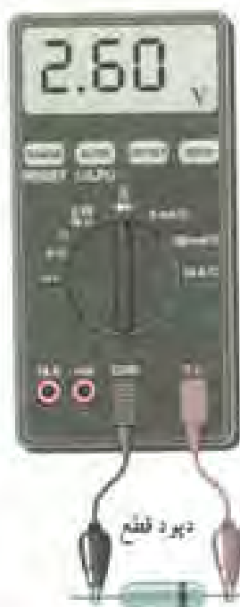
شکل ۶-۲۲- تست دیود معیوب (قطع)
