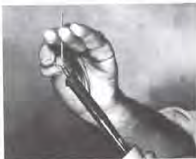
شکل ۱-۲۶- نحوه‌ی صحیح در دست گرفتن سیم و هویه برای
