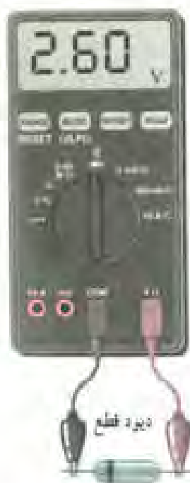
شکل ۶-۲۲- تست دیود معیوب (قطع)
