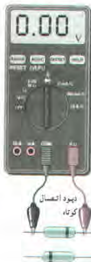
شکل ۶-۲۳ تست دیود اتصال کوتاه
