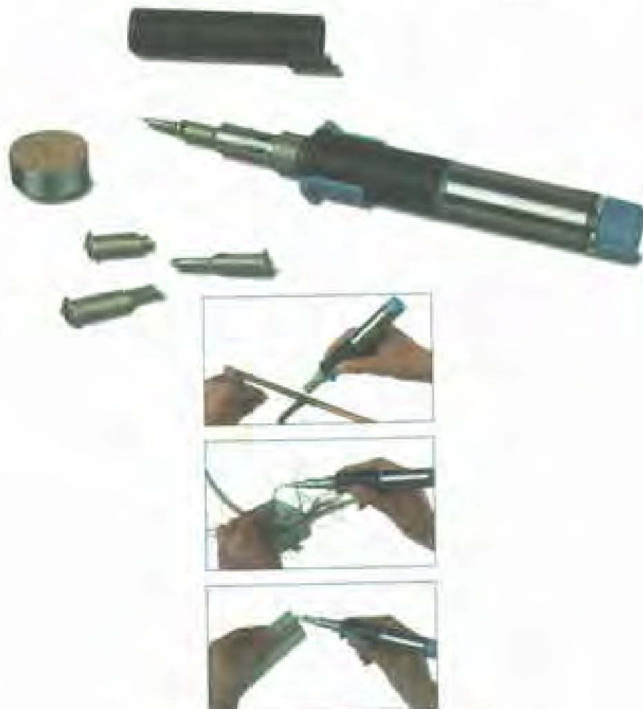
شکل ۱۱-۱-۱ هویه گازی با نوک قابل تعویض
