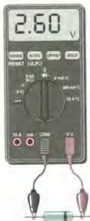
شکل ۶-۲۱- نحوه‌ی تست دیود با اهم‌متر دیجیتال
