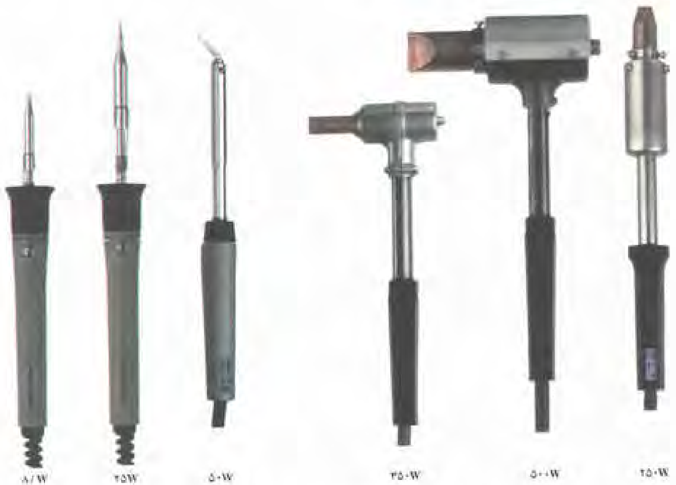
شکل ۱-۶ انواع هویه‌های قلمی در توان‌ها و اندازه‌های مختلف
