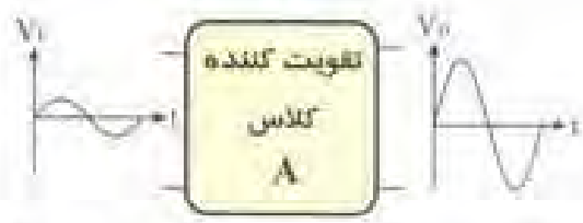
شکل ۴-۱-۲-۱ در تقویت کننده کلاس A تمامی قسمت های یک سیکل کامل و تناوب ورودی تقویت می شود.
