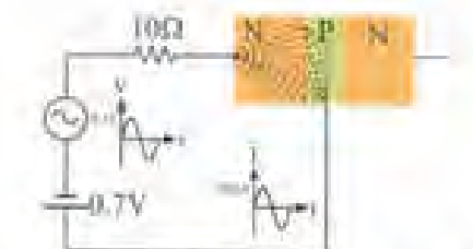
الف - عبور جریان سینوسی از لایه PN ترانزیستور با دامنه 10 میلی آمپر
