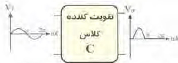
الف- در تقویت کننده کلاس C فقط قسمت کمی از نیم سیکل مثبت یا منفی تقویت می شود
