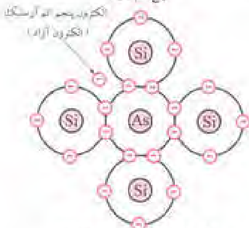
شکل ۱۱-۱- سیلیکون ناخالص شده
