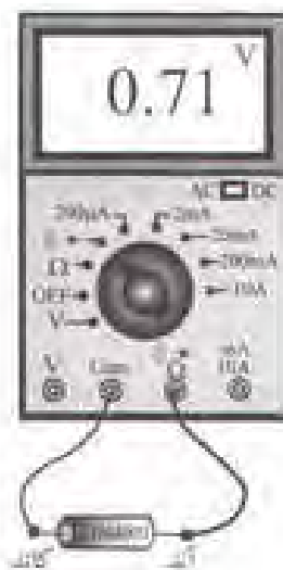
شکل ۲-۱۴- اگر دیود سالم باشد ولتاژ دو سر آن ۰/۷ ولت خواهد شد.
