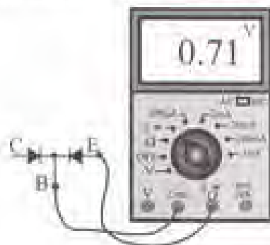
شکل ۱۹-۲ نحوه تشخیص ترانزیستور PNP و NPN به کمک آمومتر دیجیتال
