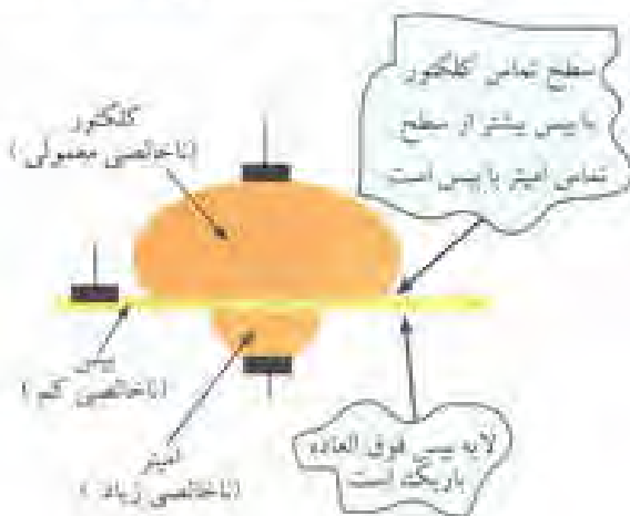
شکل ۲-۱- نحوه‌ی قرار گرفتن نیمه هادی‌های نوع N و P در ترانزیستور
