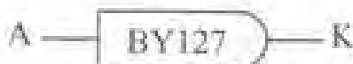
شکل ۳۷- نحوه نام گذاری دیودها به روش جدید. جنس دیود سیلیکون و نوع آن بگویند، قدرت است.
