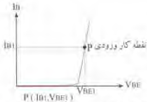
شکل ۸-۲۰- نقطه کار ورودی روی منحنی مشخصه ورودی مشخص شده است.
