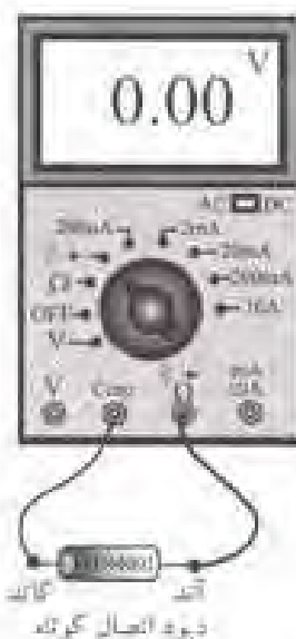
شکل ۲-۱۵- اگر دیود اتصال کوتاه باشد ولتاژ دو سر آن صفر ولت خواهد شد.
