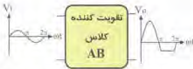
شکل ۴-۲- تقویت کننده کلاس AB. سیگنال را از 180^\circ درجه بیشتر و از 26^\circ درجه کمتر تقویت می کند.
