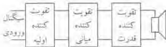
شکل ۴-۳۱ در یک تقویت کننده صوتی تقویت کننده قدرت در طبقه انتهایی قرار می گیرد.
