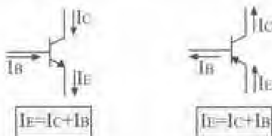
شکل ۲-۸- رابطه بین جریان ها در ترانزیستور
