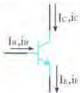
شکل ۱-۲ تغییرات جریان بیس باعث تغییر جریان کلکتور می شود.
