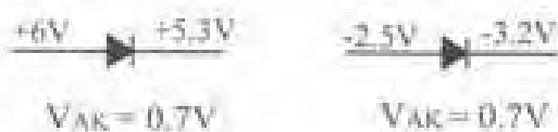
شکل ۱-۶۷- اگر ولتاژ آند تقریباً 0.7\text{ V} ولت مثبت‌تر از کاتد باشد دیود هدایت می‌کند.
