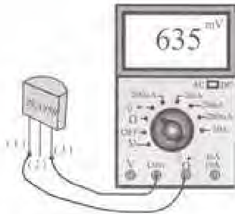
شکل ۲-۲۱- مدار آزمایش هنگام اندازه‌گیری V_{1,3}
