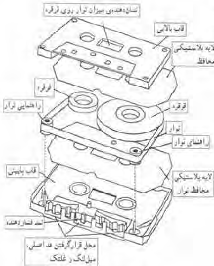
شکل ۵-۸- اجزای قطعات نوار کاست
