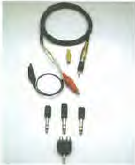
شکل ۳-۵۵- نوعی ساخت فیس رابط برای دریافت خروجی از دستگاه پخش صوت به صورت مونو
