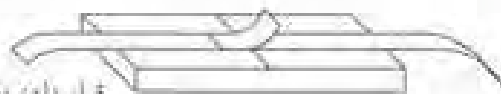
قرار دادن در قطعه نوار در کنار چسباندن نوار با یک قطعه چسب شبیه‌ای
