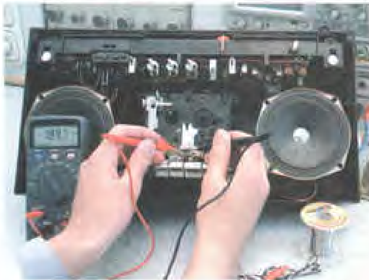
شکل ۱-۴۹ اندازه‌گیری مقاومت هد برای تعیین قطع‌شدگی. اتصال کوتاه و با اتصال به نقطه‌ی زمین
