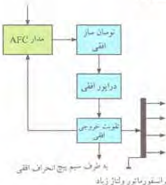
شکل ۱-۷۵ - بلوک دیاگرام خروجی افقی
