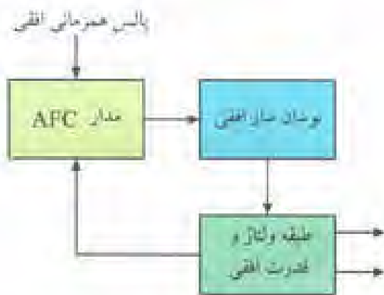
شکل ۱-۲۲- ارتباط نوسان ساز با مدار AFC
