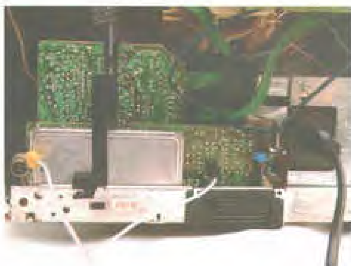
شکل ۱-۶۸ - پایه‌ی ۵ آی‌سی ۲۲۶۰ به شناسی اتصال کوتاه نموده است.
