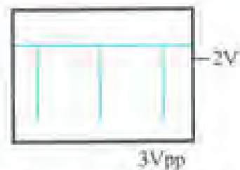
شکل ۲-۵۱ - شکل موج پایه‌ی ۱ آی‌سی
