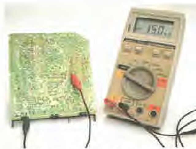
شکل ۱-۵۹- اتصال غیر صحیح مولتی‌متر به پایه‌ی آی‌سی
