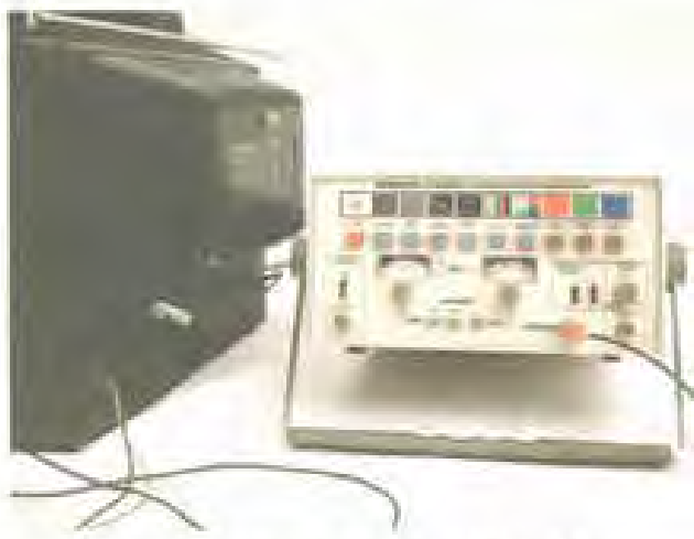
شکل ۱-۷۱ - اتصال پترون ژنراتور به تلویزیون
