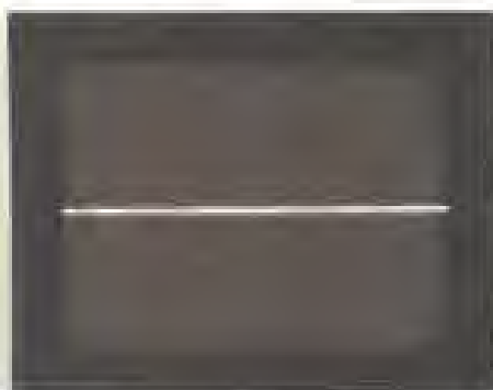
شکل ۲-۴۰ - نوسان ساز صوتی از کار افتاده است.
