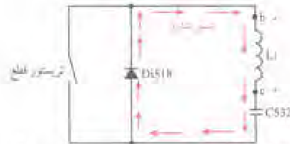
شکل ۱-۷۹- انرژی ترانسفورماتور دیود D518 را هادی می کند و خازن C522 شارژ می شود و نیمه اول رفت را به وجود می آورد.
