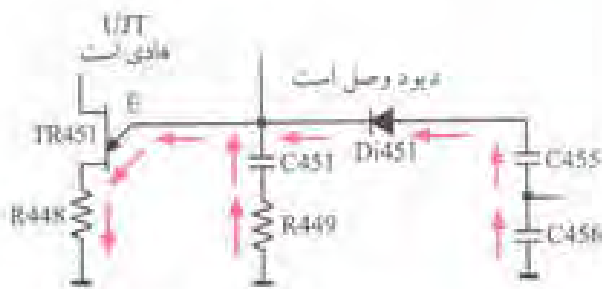
شکل ۲-۲۵- از طریق D451 و امیتر UJT دشارژ می‌کند
