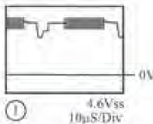
شکل ۱-۲۳- شکل موج ورودی پایه ۵ آی‌سی
