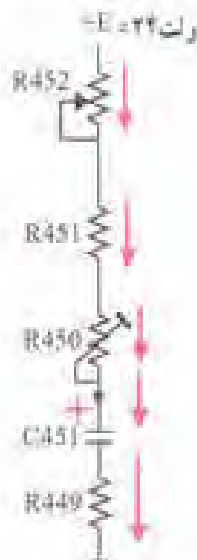
شکل ۲-۱۵ مسیر شارژ خازن C451
