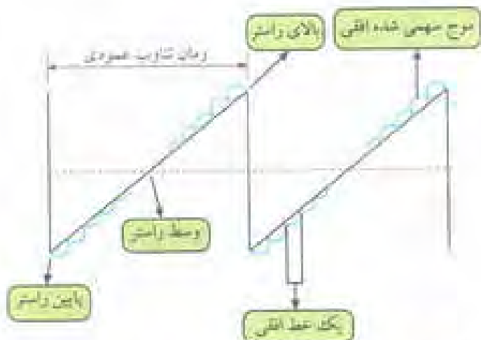
شکل ۲-۸۷ - موج عمودی که روی آن موج سهمی شده افقی مدوله شده است.
