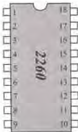
شکل ۲۰-۱- شماره پایه های آی سی ۲۲۶
