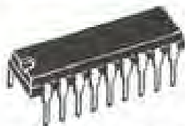
شکل ۱۹-۱- شکل ظاهری آی سی ۲۲۶
