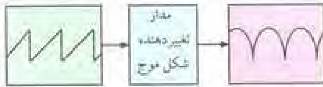
شکل ۲-۸۱- موج ورودی و خروجی تغییردهنده‌ی شکل موج
