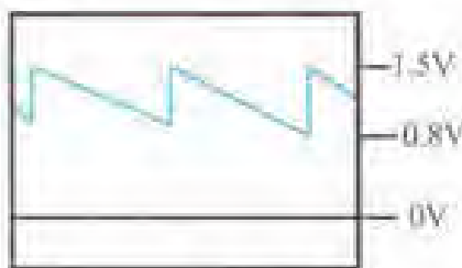
شکل ۲-۳۸ - موج برگشتی به پایه ۲ آی سی
