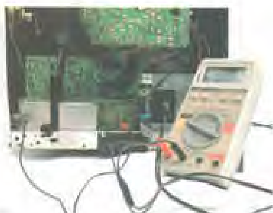
شکل ۱-۶۱- اتصال ولت‌متر به پایه‌ی ۱۰
