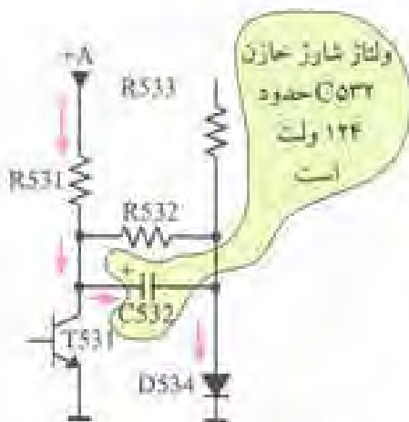
شکل ۱۵۲- مسیر شارژ خازن C532
