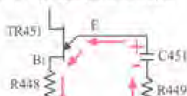
شکل ۲-۱۵ مسیر شارژ خازن C451
