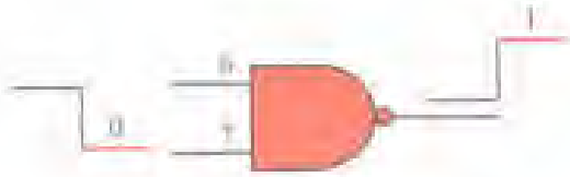
شکل ۱۰-۱۰: یک ورودی NAND صفر و خروجی آن (۱) است.
