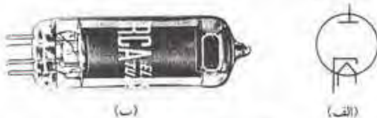
شکل (۸-۱) الف- علامت اختصاری لامپ دیود ب- شکل ظاهری لامپ دیود
