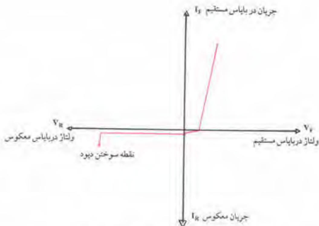
شکل (۳-۱۱) منحنی مشخصه دیود در بایاس موافق و مخالف
