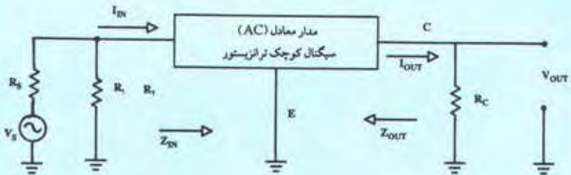
شکل (۶-۷) مدار معادل AC تقویت کننده CE
