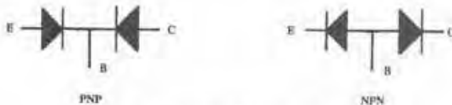
شکل (۶-۵) معادل دیودی ترانزیستور
