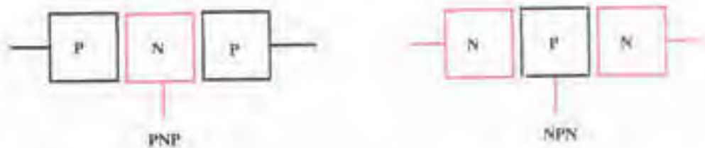
شکل (۳-۵) ساختمان ترانزیستور
