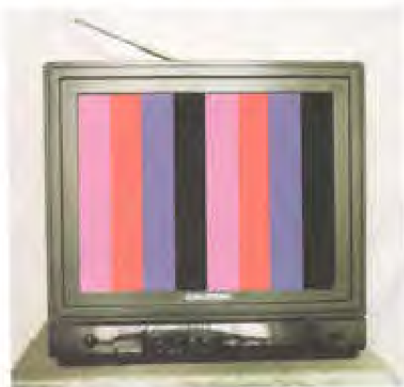
شکل ۲-۱۲۷- تصویر نوار رنگی استاندارد بدون رنگ سبز
