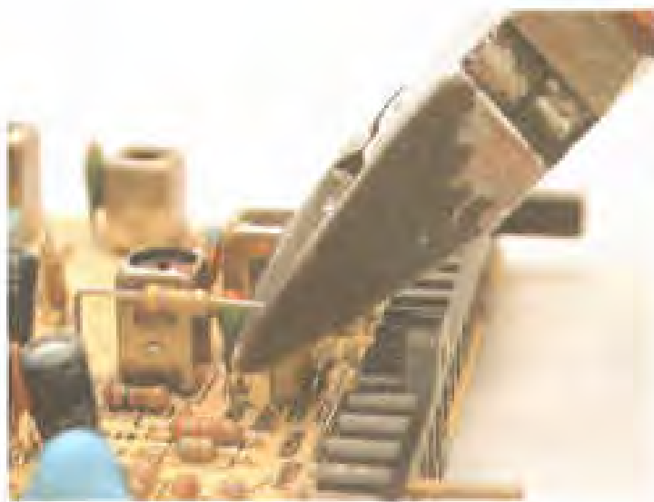
شکل ۲۹-۴- قطع کردن پایه بلند المان‌ها برای ایجاد صیب
