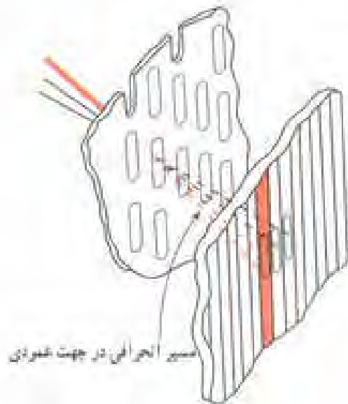
شکل ۱-۸۴- خطای عمودی تأثیری در خلوص رنگ ندارد.
