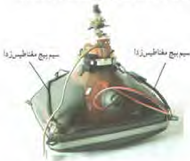
شکل ۱۰۵ - مدار سیستم دگوسینگ در تلویزیون گروتینگ
