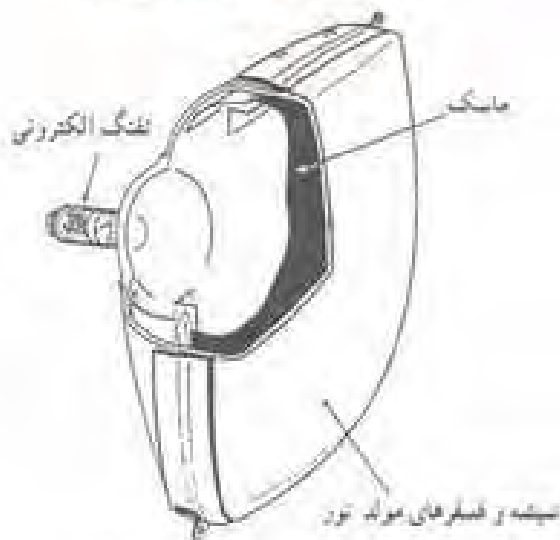
شکل ۸۱-۱- ماسک و صفحه‌ی لامب کاملاً ثابت هستند
