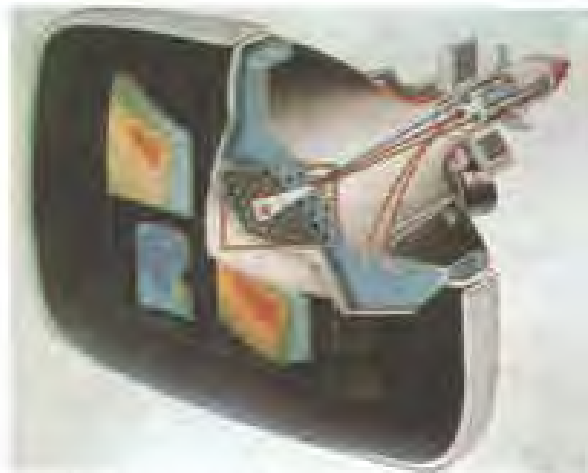
شکل ۱-۶ هر شعاع الکترونی به مواد فسفوری مربوط به رنگ خود برخورد می‌کند
