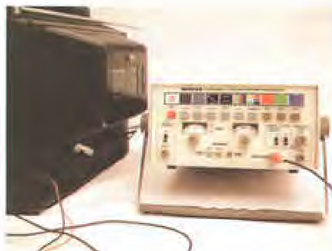
شکل ۱-۱۲۳- اتصال خروجی RF پترن ژنراتور به ورودی آنتن تلویزیون
