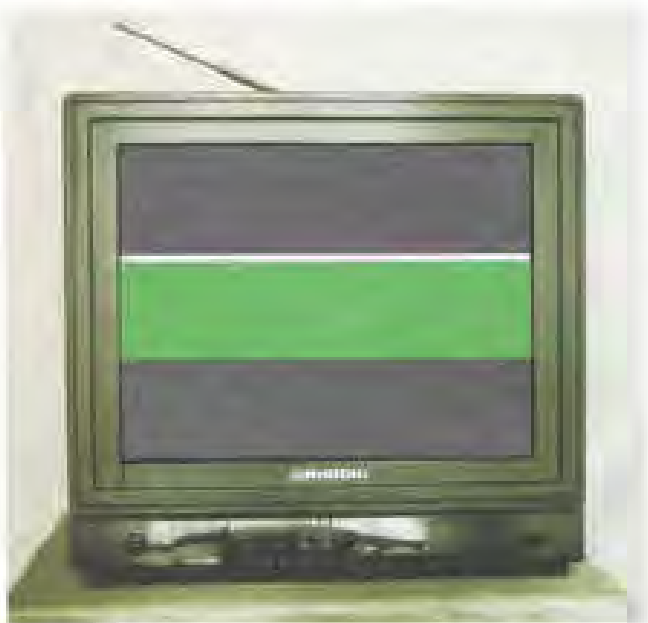
شکل ۲-۱۱۶ تصویر تلویزیون وقتی C518 قطع است.
