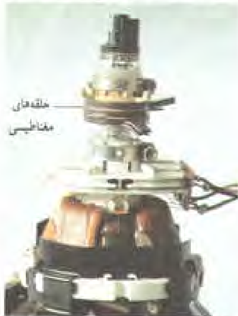
شکل ۹۸-۱ حلقه‌های مغناطیسی روی گردن لامپ
