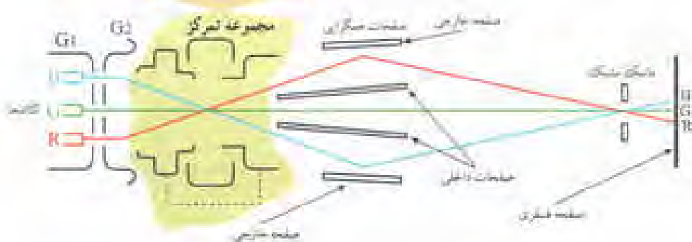
شکل ۱-۳۴- هدایت اشعه‌ها به مجموعه فوکوس کننده
