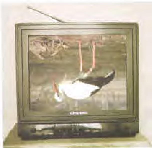
شکل ۲-۹۸- تصویر وارونه روی صفحه‌ی تلویزیون
