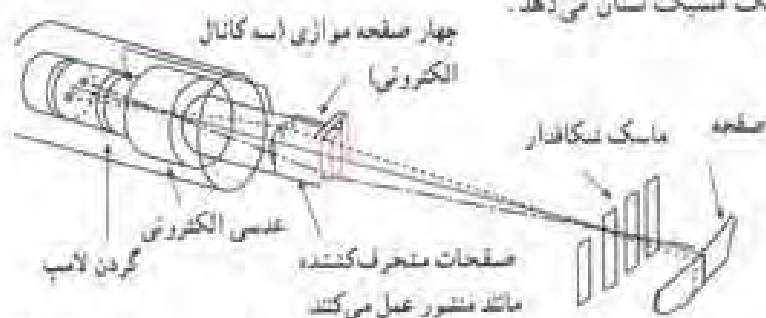
شکل ۱-۳۷ - اشعه‌ی سبز بدون تغییر جهت خارج شده است.
