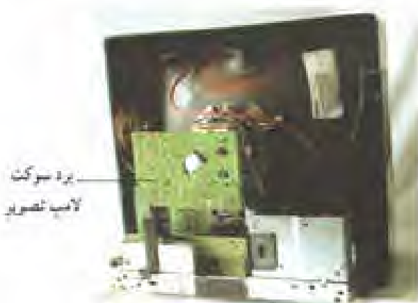
الف- برد سوکت لامپ تصویر متصل به تلفنگ الکترونی
