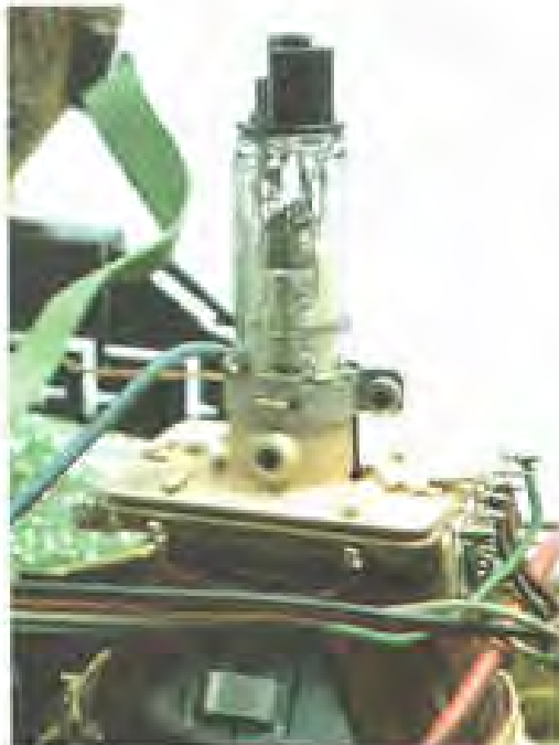
شکل ۷۱-الف- شکل لامپ تصویر و پایه‌های آن
