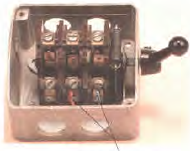
سیم‌های مربوط به تعویض جای دو فاز
