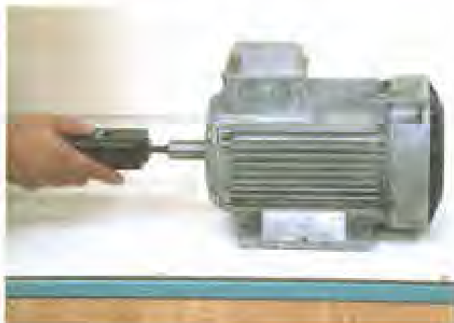
شکل ۱-۳۲- در حال اندازه گیری تور موتور
