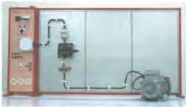
شکل ۱۴۲-۱- نمای قطعات نصب شده به همراه کابل و موتور متصل شده.
