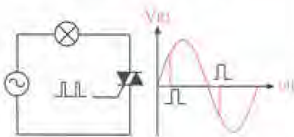
شکل ۱-۵-۶- تریاک هم در نیم سیکل مثبت و هم در نیم سیکل منفی می تواند شکل موج را برش دهد.
