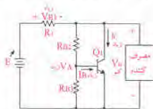
شکل ۱۰-۱- تنظیم ولتاژ خروجی به‌ازای افزایش جریان بار
