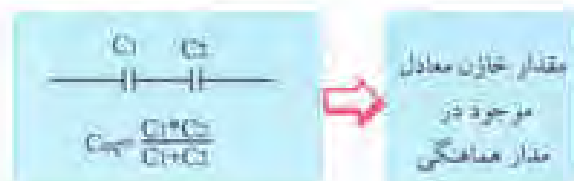
شکل ۳-۱۶- در رابطه فرکانس توسان باید به‌جای L و C معادل سلف و خازن دیده شده در مدار قرار داد.
