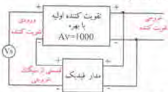
شکل ۲-۴- ب- سیگنال خروجی باعث تقویت سیگنال ورودی می‌شود (فیدبک مثبت)
