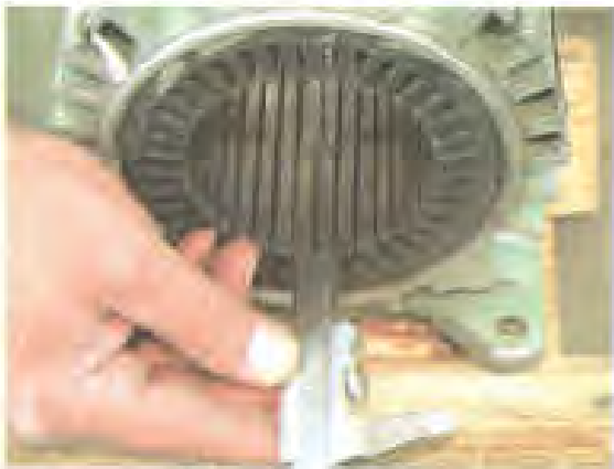
شکل ۲-۲۶- اندازه‌گیری محیط داخلی و طول شیار
