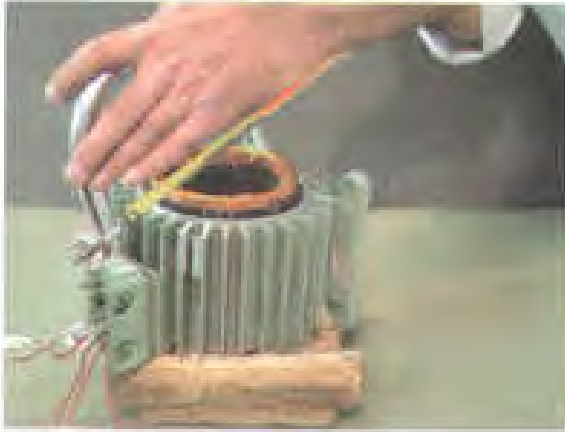
شکل ۱۶-۲- برش پیچک‌ها و شمارش تعداد دور
