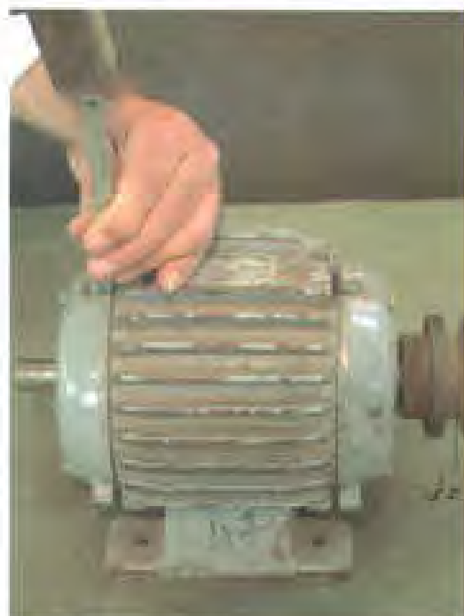
شکل ۱۰-۱- استفاده از چکش فلزی برای علامت‌گذاری در بازگردن قطعات موتور
