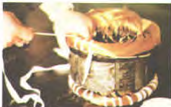
شکل ۴-۱۸ – توار بندی سیم‌های استاتور
