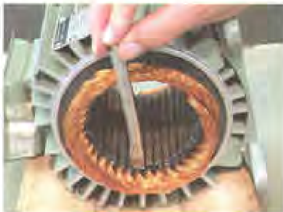
الف - قرار دادن قلم روی سیم‌ها
