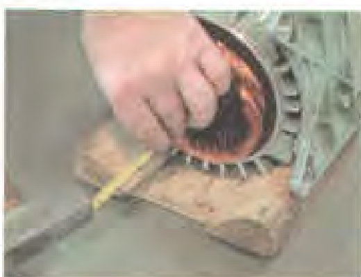
شکل ۲-۲۲ - بیرون آوردن گوه یا کاغذ برشمان از داخل سیم ها
