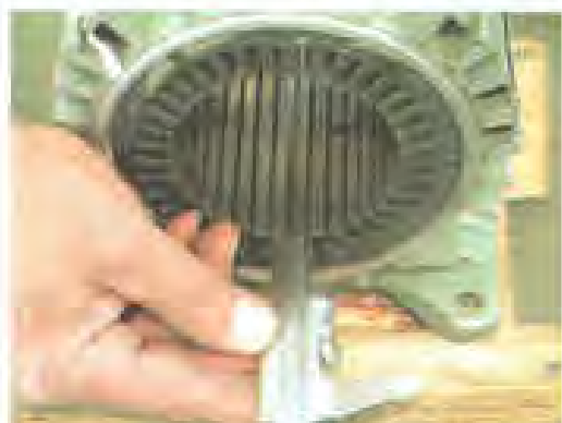
شکل ۲-۳۲- اندازه‌گیری طول شیار
