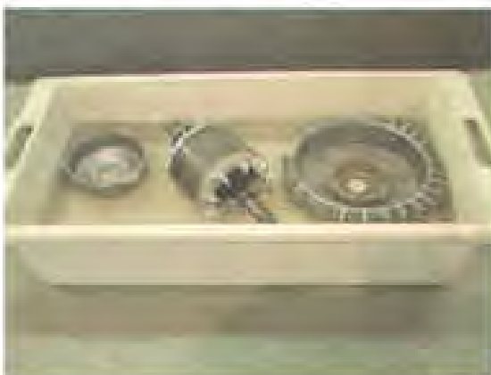
شکل ۱-۳۲ - تست و شوی قطعات با آب گرم
