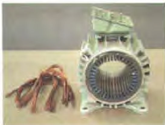
شکل ۲-۲۴ – سیم‌های بیرون آمده از استاتور
