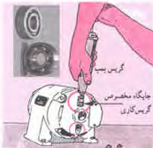
شکل ۱-۳۳ - گریس کاری بلبرینگ‌ها
