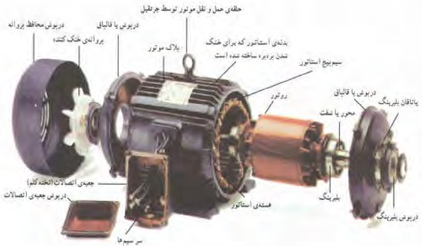
شکل ۱-۳- اجزای اصلی موتور سه‌فاز
