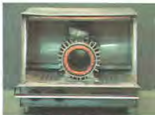
شکل ۲۰-۴-۲۰ گرم کردن استاتور
