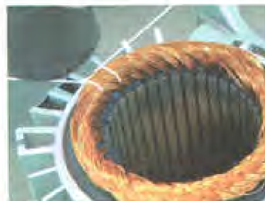
شکل ۱۶-۴- کشیدن نخ و زدن سرریز ملایم روی آن
