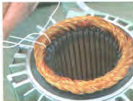
شکل ۱۵-۴- عبور نخ از تیارها و گره خوردن آن
