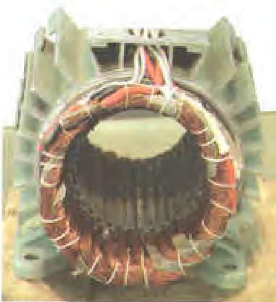
شکل ۴-۱۷ – نمایش استاتور نخ‌بندی شده از دو سمت
