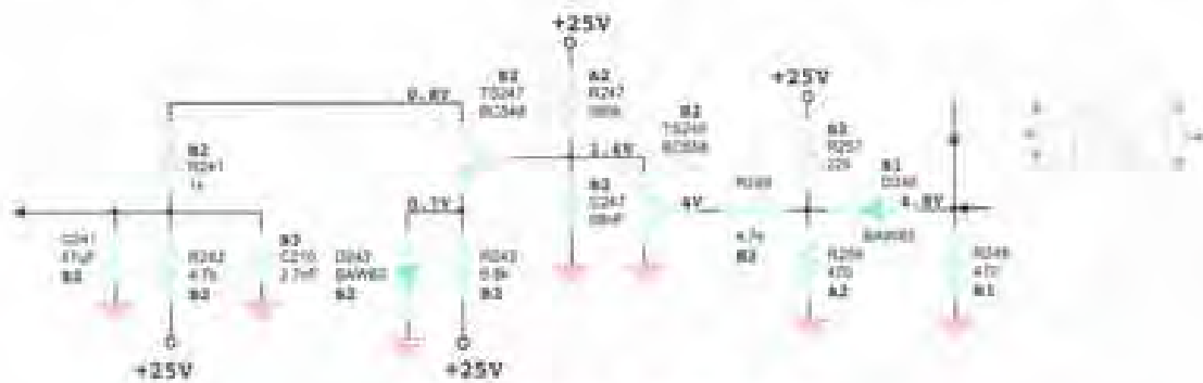
شکل ۴-۵۱ مدار AGC پیگ
