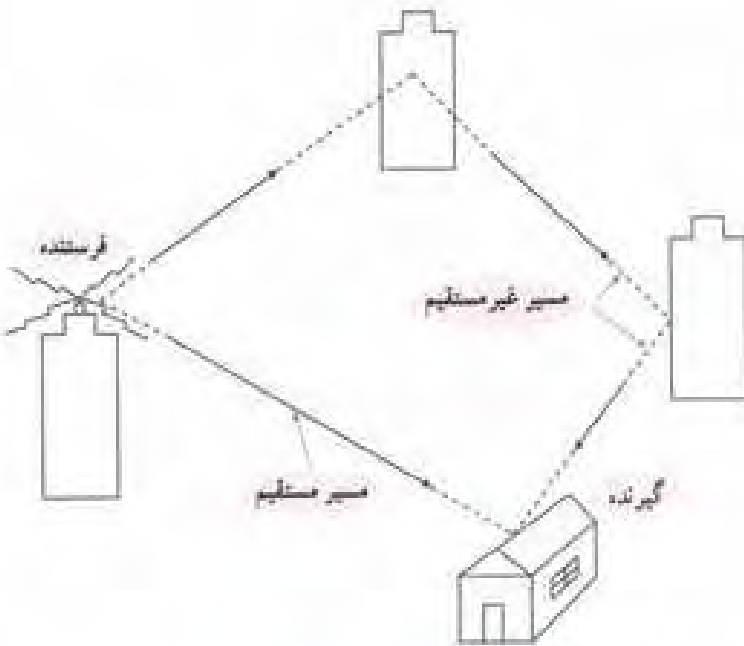
شکل ۴-۱- دامنه سیگنال در فاصله‌های مختلف گیرنده نسبت به فرستنده، فرق می‌کند.
