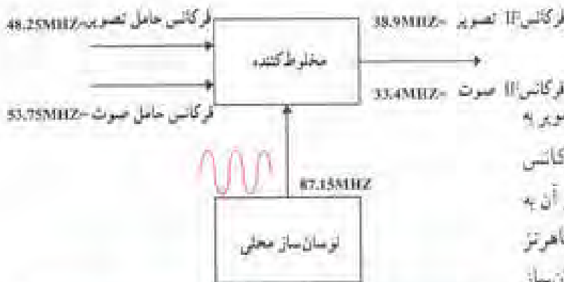
شکل ۲-۱۰ - بلوک دیاگرام عملکرد مدار نوسان ساز محلی
