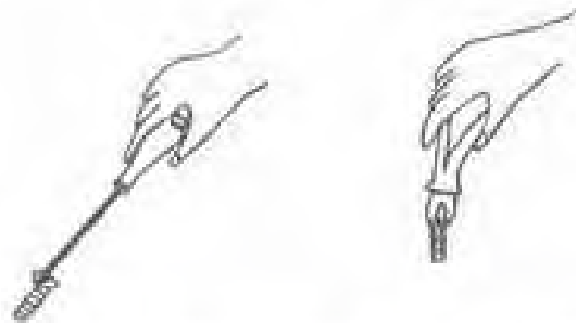
استفاده صحیح از بیج گونشی برای باز کردن و بستن بیج
