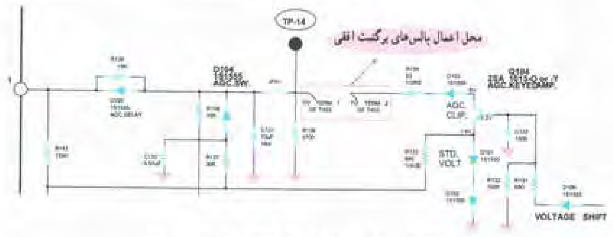
شکل ۲-۲۲ - محل اتصال پالس‌های برگشت افقی به طبقه AGC روی نقشه
