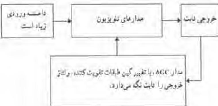
شکل ۴-۶- عملکرد مدار AGC در تلویزیون
