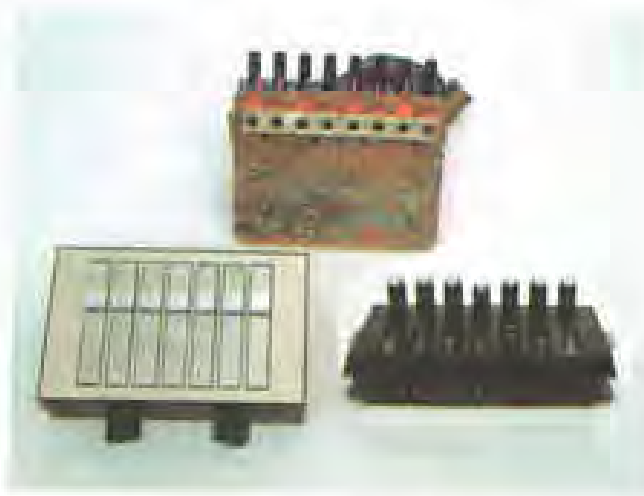
شکل ۲-۲۲- کلیدهای پوش با تون و فینگر تاج
