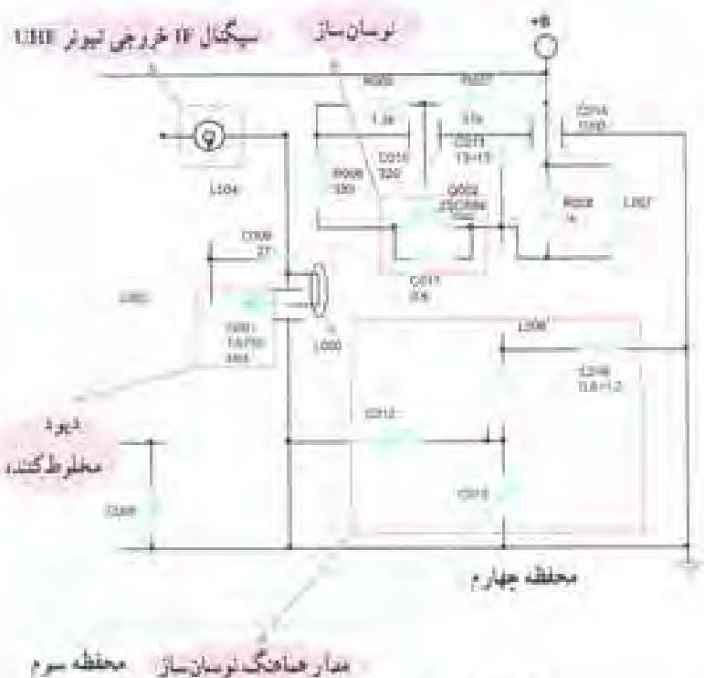
شکل ۲-۲۶ - مدار نوسان ساز تیونر UHF
