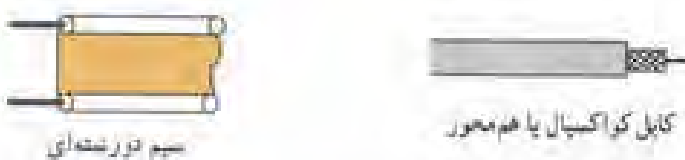
شکل ۱-۲۲- ب - خط انتقال دو سیمه و هم محور
