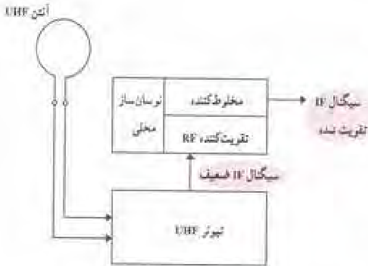
شکل ۲-۴۱- نقش تیونر VHF در هنگام استفاده از تیونر UHF
