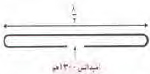
شکل ۱-۹ - مقاومت ۳۰ اهم از آنتن دیپل ناشده
