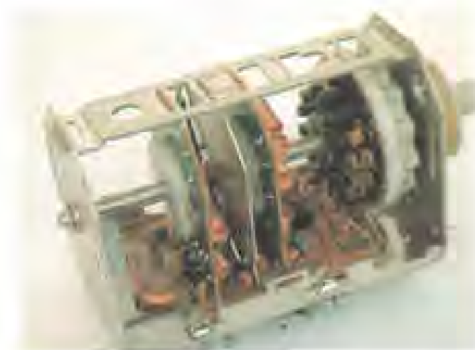
شکل ۱۹-۲- نمایش اتصالات فتری و جرخ دنده ها در تیونر
