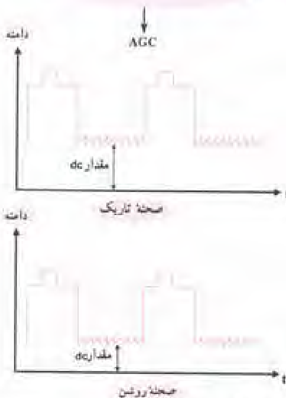
شکل ۳-۲- سیگنال مرکب تصویر برای صحنه‌هایی با روشنایی کم و زیاد
