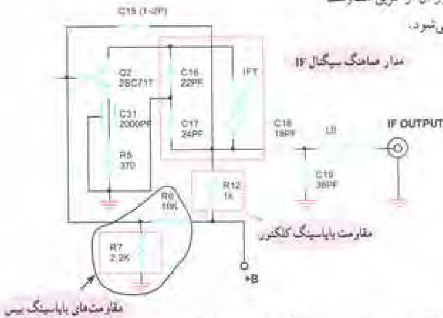
شکل ۲-۳۹ - مقاومت‌های بایاسینگ ترانزیستور مخلوط‌کننده
