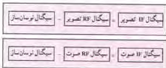
شکل ۸-۲- بلوک دیاگرام عملکرد مخلوط کننده
