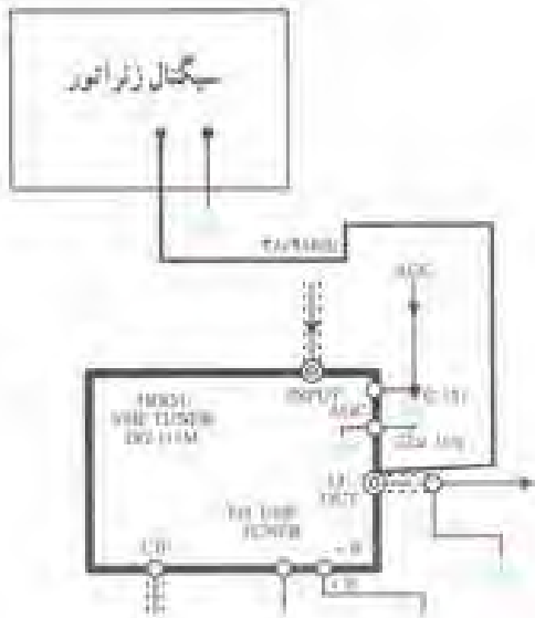
شکل ۶۴-۲- اتصال سیگنال ژنراتور به کابل ورودی (۱)
