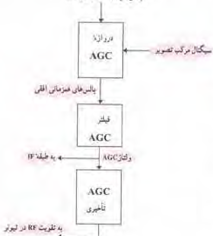
شکل ۴-۹- بلوک دیگر ام مدار AGC کلیدی و تأخیری
