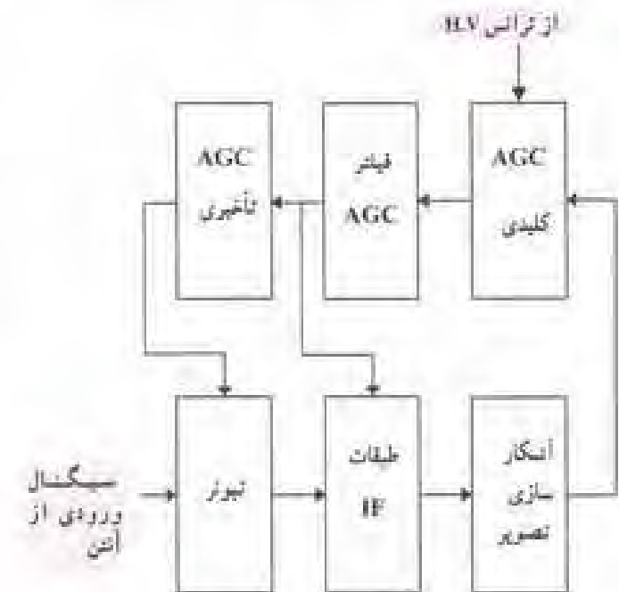
شکل ۴-۱۱ اعمال ولتاژ AGC به طبقات IF و تیوپر
