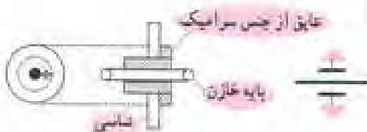
الف - نماد مداری خازن فیدترو ب - ساختمان داخلی خازن فیدترو
