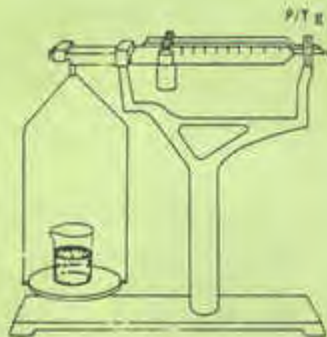
ترازوی سه‌اهرمی برای توزین سریع و تقریبی در آزمایشگاه (میزان دقت تا ۰/۰۰۱ گرم)
