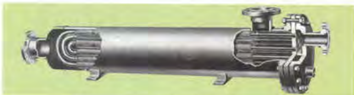
شکل ۷-۵- ساختمان داخلی مبدل‌های حرارتی پوسته - لوله.
