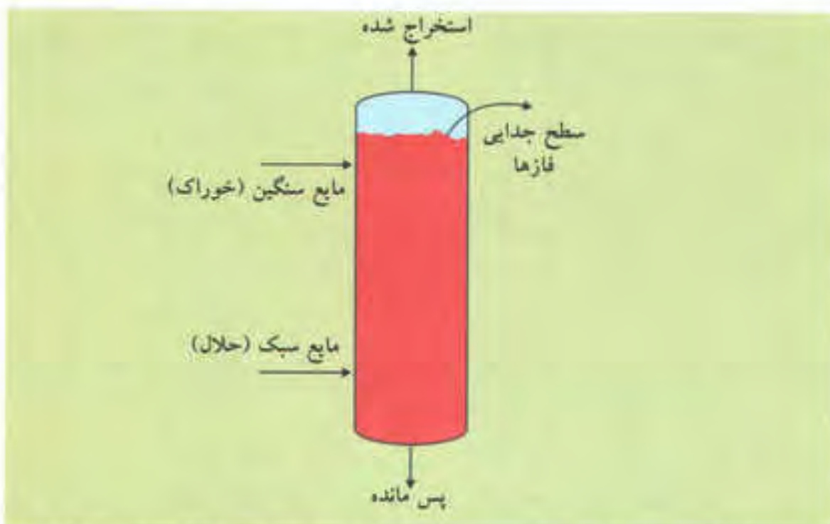
شکل ۱۱-۲۲- عملیات استخراج تک مرحله‌ای در برج پاششی وقتی خوراک سنگین‌تر از حلال باشد.
