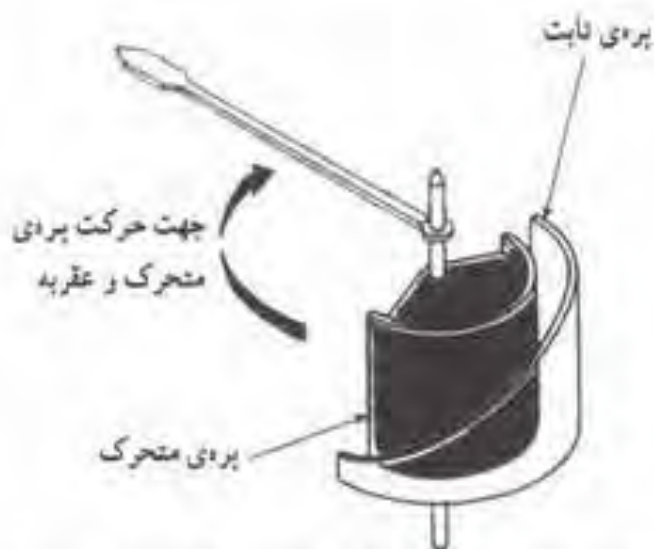
شکل ۳-۴۱ - بره‌ی ثابت از یک شیب برخوردار است تا یک میدان غیر یک نواخت بین دو بره به‌وجود آید.
