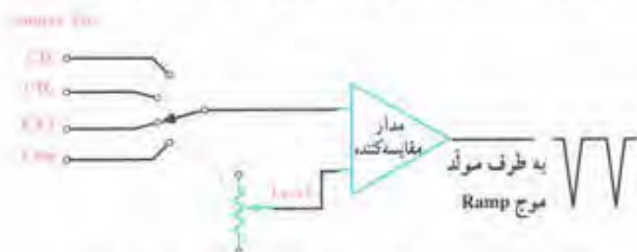
شکل ۴-۳۴- بلوک دیاگرام منبع تأمین پالس‌های فرمان به مولد موج Ramp
