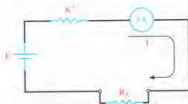
شکل ۳-۲۹- مدار ساده‌ی یک اهم متر سری
