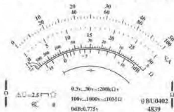
شکل ۳-۳۲- درجه‌بندی‌های ولتاژ، جریان و مقاومت اهمی روی یک صفحه‌ی مدرج یک آمومتر
