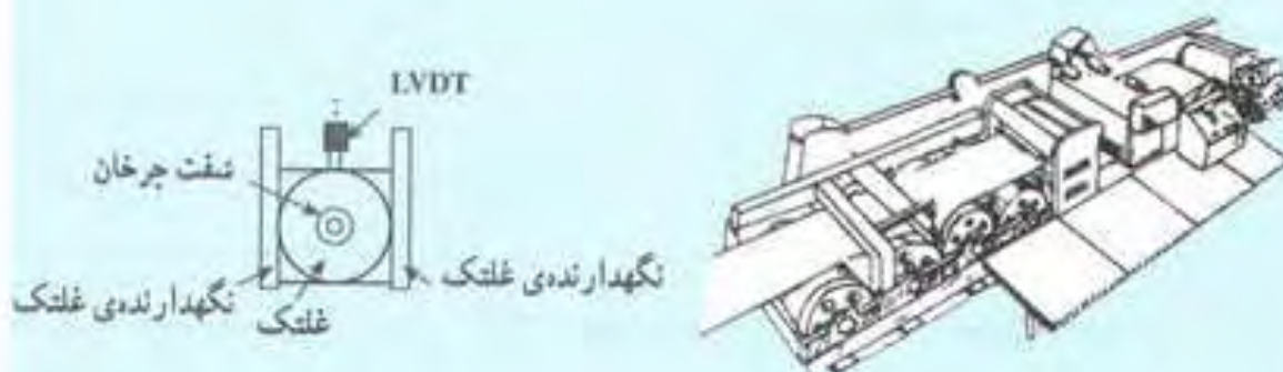
شکل ۴-۵- کاربرد LVDT در غلتک ریلی به عنوان اندازه‌گیر ضخامت ورقی نورد شده
