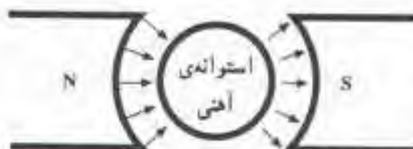
شکل ۳-۳- چگونه ایجاد میدان مغناطیسی یک‌نواخت و شعاعی
