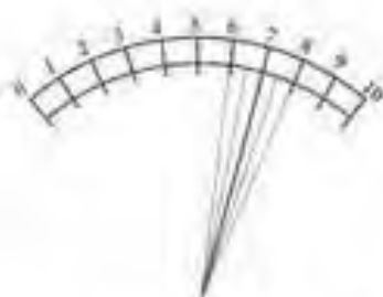
شکل ۳-۴۴- عقربه، قبل از این که مقدار صحیح را نشان دهد چندین بار در طول آن نوسان می‌کند.
