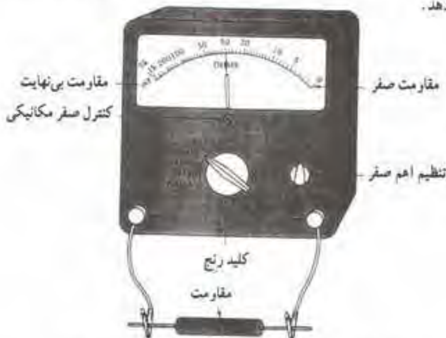
شکل ۲۷-۱- اهم‌تر در حال اندازه‌گیری یک مقاومت 300 \Omega
