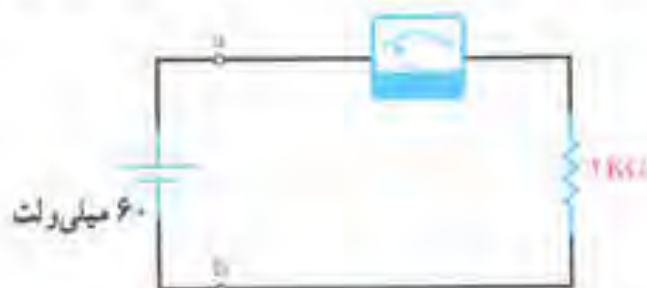
شکل ۳-۱۱- به‌ازای اعمال 60mV ولتاژ به گالوانومتر، انحراف 50\% خواهد بود.
