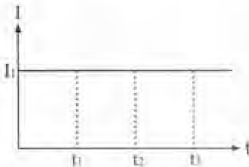
شکل ۱-۱۷- شکل جریان ثابت در زمان‌های t_1 ، t_2 و t_3 جریان همواره ثابت است.
