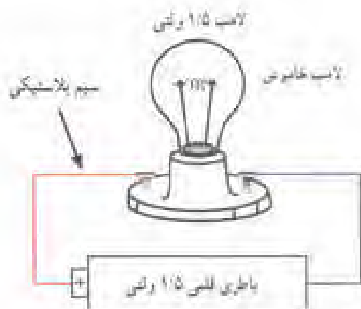
شکل ۱-۱- سیم از جنس پلاستیک جریان برق را به راحتی از خود عبور نمی‌دهد لذا عایق است.
