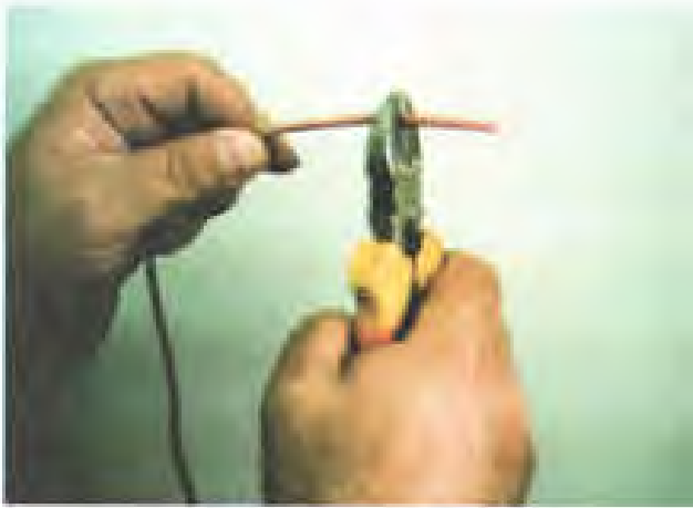
شکل ۲-۱۳- نحوه بریدن سیم با سیم چین
