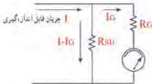
شکل ۹-۱۰-۱ با موازی کردن یک مقاومت با گالوانومتر جریان های بیشتر از جریان مجاز گالوانومتر را می توان اندازه گرفت.
