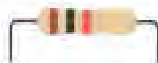
شکل ۳-۳۱- پایه های مقاومت ها، دیودها و... را به این صورت خم کنید.
