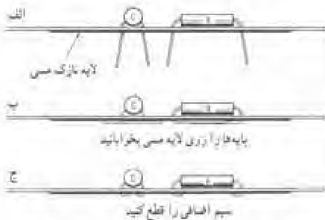
شکل ۳-۲۰- نحوه قرار دادن امراجل قرار دادن الحازن و مقاومت روی مدار چاپی جهت لحیم کاری
