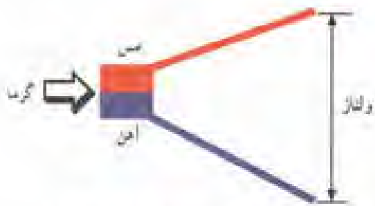
شکل الف - ۱-۶۷ - ساختار یک ترموکوپل که با برسی کردن در جسی مختلف به جود آمده است.
