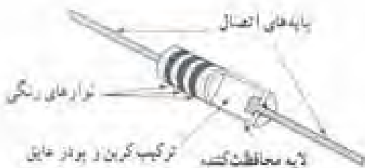
شکل ۱-۳۷ - ساختمان داخلی مقاومت نوع ترکیبی
