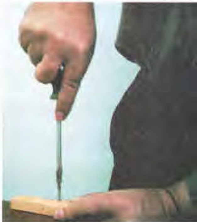
شکل ۲-۵- نحوه درست در دست گرفتن پیچ‌گوشتی هنگام باز کردن یا بستن پیچ
