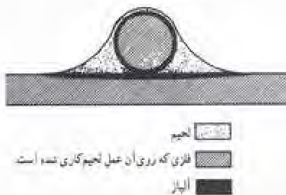
شکل ۳-۴- نحوه اتصال دو فلز به کمک آلیاژ لحیم
