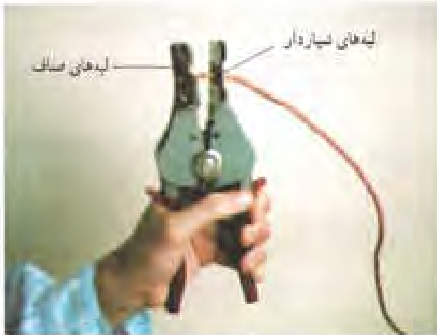
شکل ۲-۱۶ نحوه روپوش برداری به کمک سیم لخت‌کن اتوماتیک
