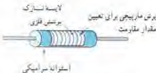
شکل ۱-۳۸ - ساختمان داخلی مقاومت اکسید فلزی
