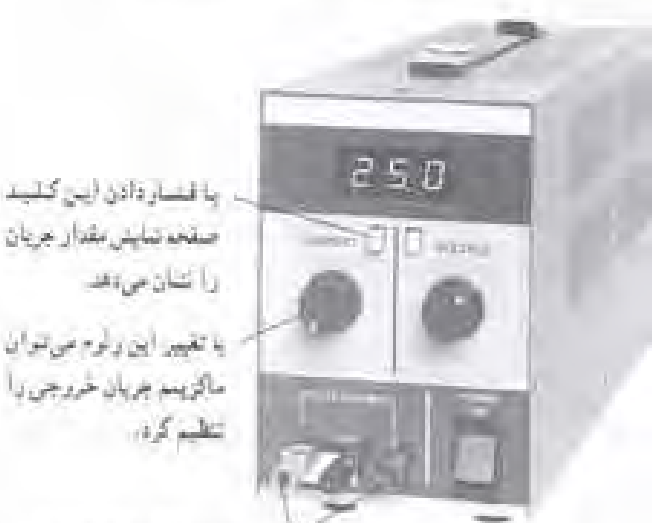
با یک سیم رابط دو ترمینال خروجی را اتصال کوتاه می‌کنیم.
