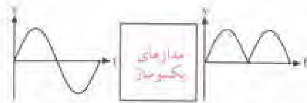
شکل ۱-۴۰ به کمک مدارات یکسوساز می توان جریان های غیر یک طرفه (دو طرفه) را به جریان های مستقیم تبدیل کرد.
