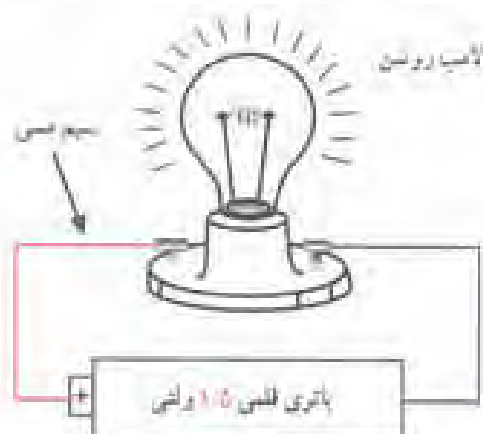
شکل ۱۰-۱-۱ سیم مسی به راحتی جریان برقی را از خود عبور می‌دهد لذا هادی خوبی است.
