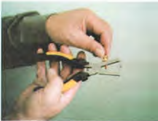
شکل ۲-۱۴- نحوه تنظیم دهانه سیم لخت‌کن دستی
