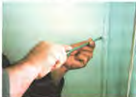
ب: یک پیچ بزرگ را باید با یک عدد پیچ‌گوشی بزرگ باز یا بسته کرد.
