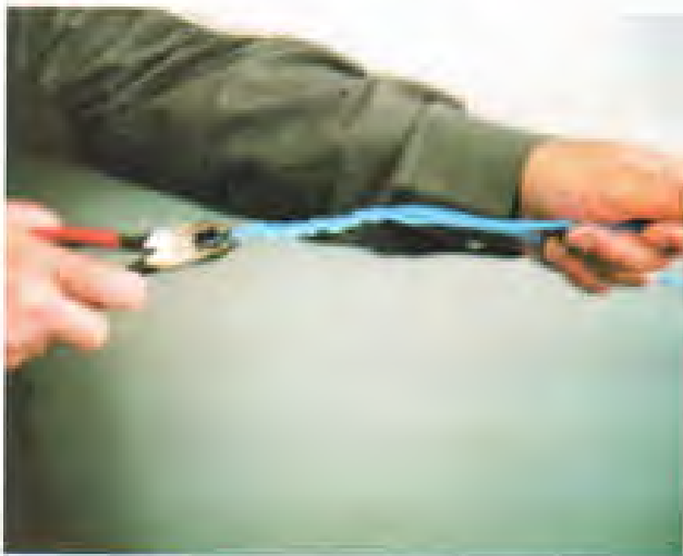
به کمک ابزار دست می‌توان دو رشته سیم را به یکدیگر تاباند. شکل ۲-۸-۲ در نمونه کاربرد سیم چین
