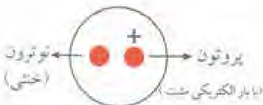
شکل ۱-۳- هسته اتم دارای دو نوع ذره است پروتون یا بار مثبت و نوترون که از نظر الکتریکی خنثی است.
