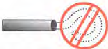
شکل ۲۶-۴ سیم سوزنی شده را داخل بیج قرار دهید و بیج را با بیج گوتشی سفت کنید.
