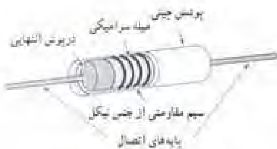
شکل ۱-۳۶ - ساختمان داخلی مقاومت سیمی
