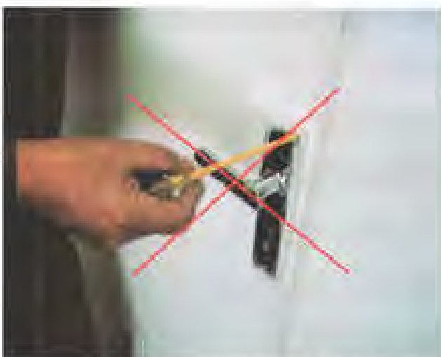
شکل ۲-۳۱- از بیج‌گوشی تنظیم نباید برای باز و بسته کردن بیج استفاده کرد.
