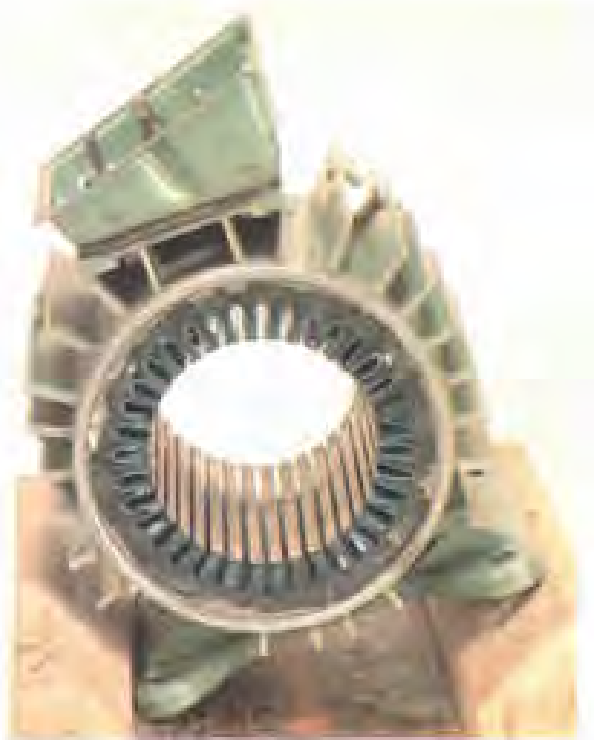
شکل ۲-۱۳- انتخاب شیار شروع و مسیر کلاف‌گذاری
