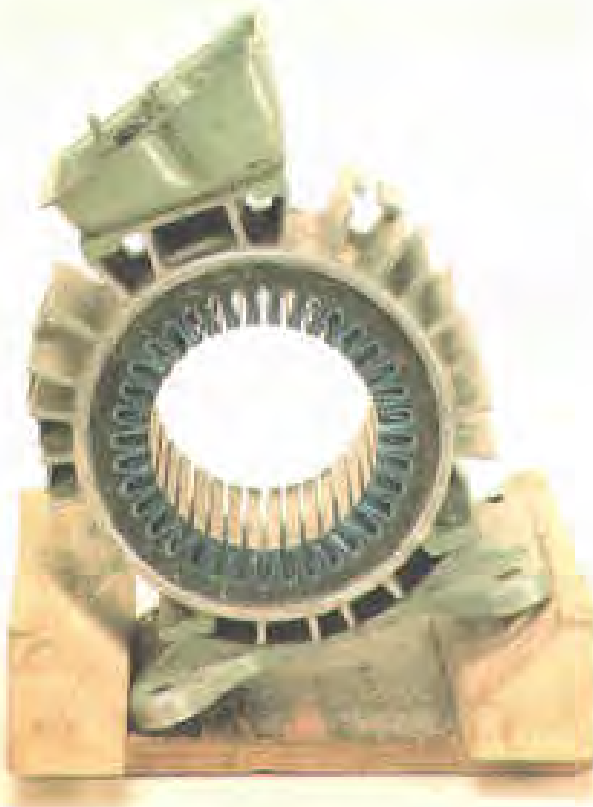
شکل ۲۹-۲-ب- انتخاب شماره شروع سیم‌بندی
