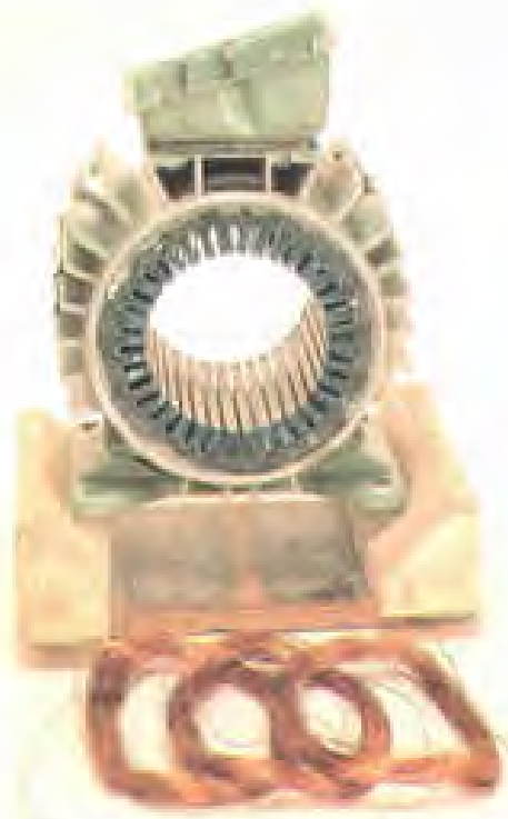
شکل ۲-۵ - موقعیت کلاف‌ها در مقابل استاتور، قبل از جاگذاری آن‌ها در داخل استاتور
