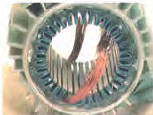
شکل ۳-۱۰ - طول کاغذ برشمان از هر طرف تیار حدود ۲ تا ۲/۵ میلی‌متر بیشتر است.
