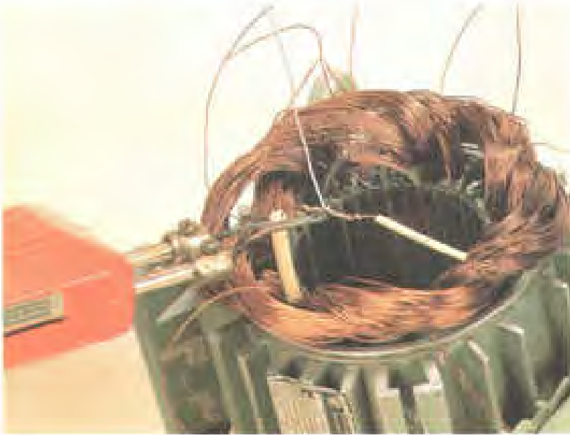
شکل ۳-۸- محل اتصال دو سیم را لحیم کنید.
