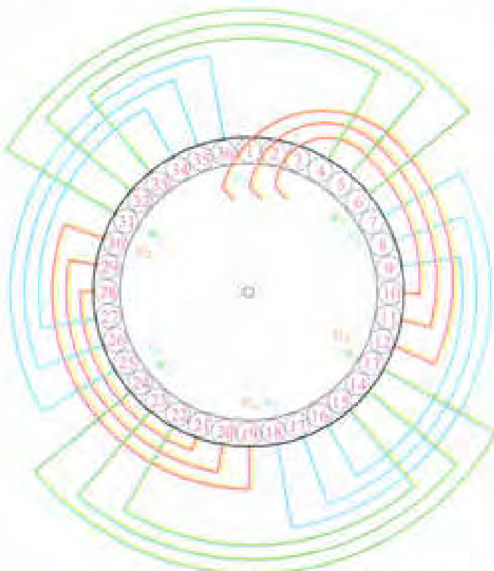
شکل ۲-۴۷- قرار دادن کلاف‌های گروه کلاف شماره ۶ در شماره‌های استاتور موتور سه فاز ۳۶ نیار یا سیم‌بندی متحدالمرکز
