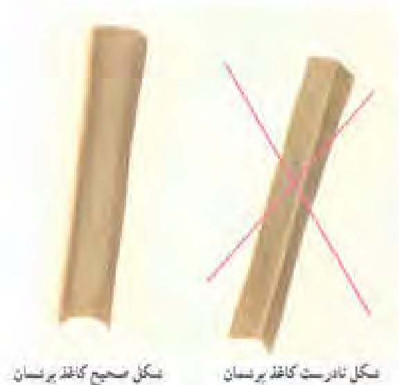
شکل ۳-۸ - انتخاب شکل صحیح کاغذ برشمان
