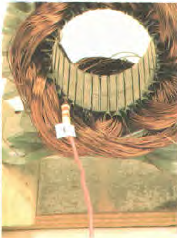
شکل ۳-۱۱- اتصال سیم اشنان به ابتدا و انتهای فلز و برجسته شدن آن
