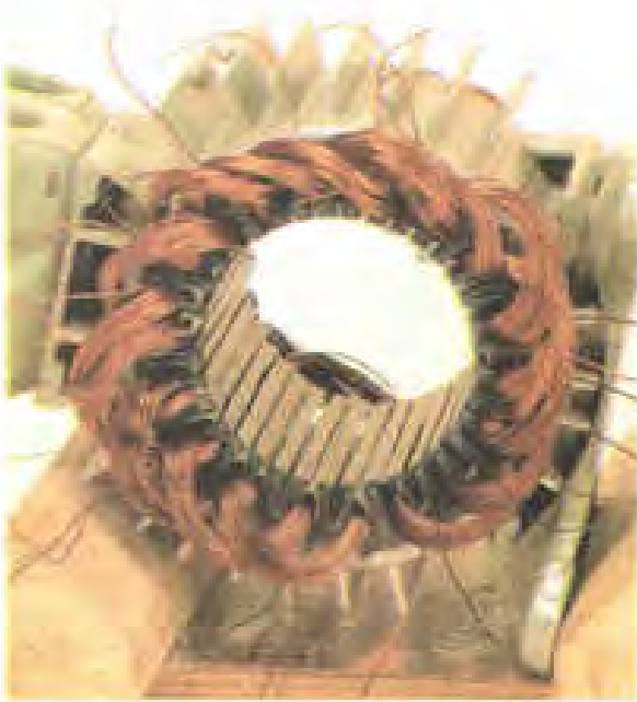
شکل ۲-۳۴- موقعیت کلاف‌ها از کلاف شماره ۱ تا کلاف شماره ۱۶
