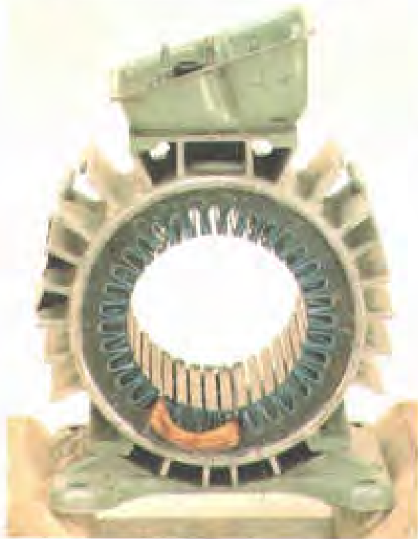
شکل ۲۹-۲-ج- قرار دادن کلاف شماره ۱
