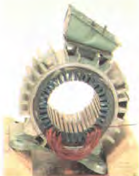
شکل ۲-۱۸- قرار گرفتن گروه کلاف شماره یک در داخل تسمیه‌ها
